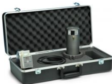
Figura 5.2.1-150 Equipamiento que conforma el kit de calibración Variflow Fuente: K2 INGENIERÍA S.A.S.
