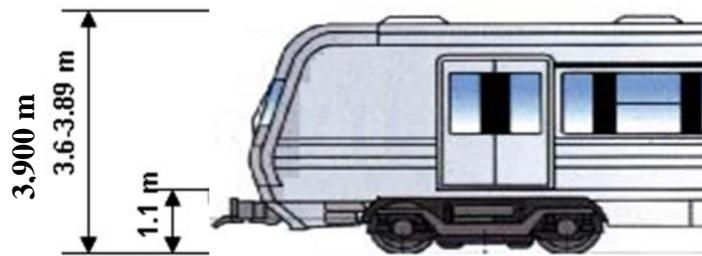
Ilustración 143. Altura del tren (esquema solo referencial)
