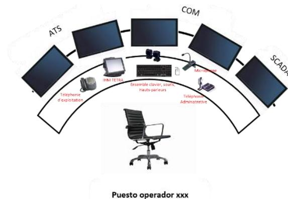
**Ilustración 136. Equipamientos COM tipo de PO**
