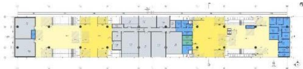
**Ilustración 83. Nivel 2 o nivel intermedio de una estación con mezzanine completo. Fuente: Elaboración propia**
