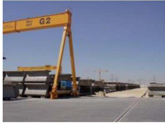
**Ilustración 157. Doble acopio de dovelas en parque de prefabricación para metro de Dubái**
