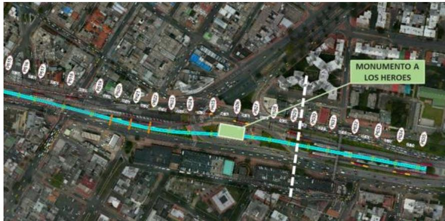
**Ilustración 19. Trazado previsto la cola de maniobras a la altura del Monumento a los Héroes. Fuente: elaboración propia**
