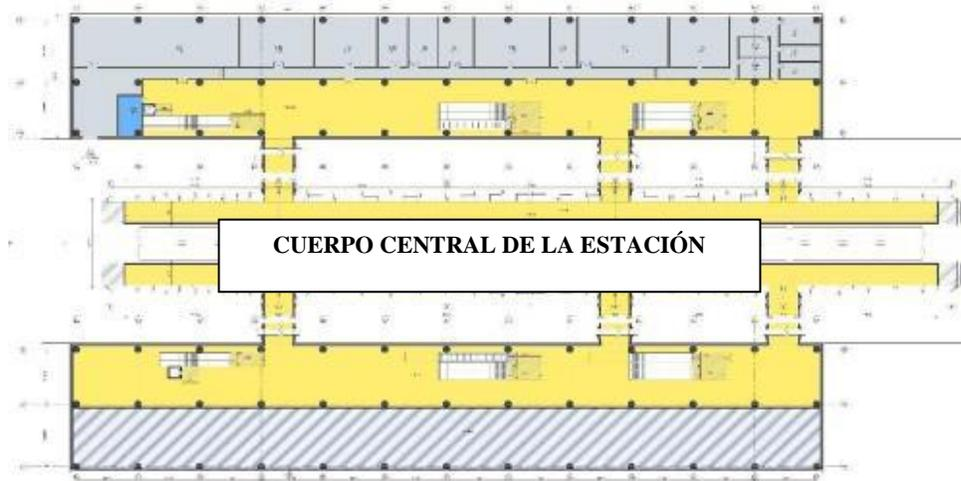
**Ilustración 79. Nivel 3 o nivel de andén de una estación interconexión. Fuente: Elaboración propia**
