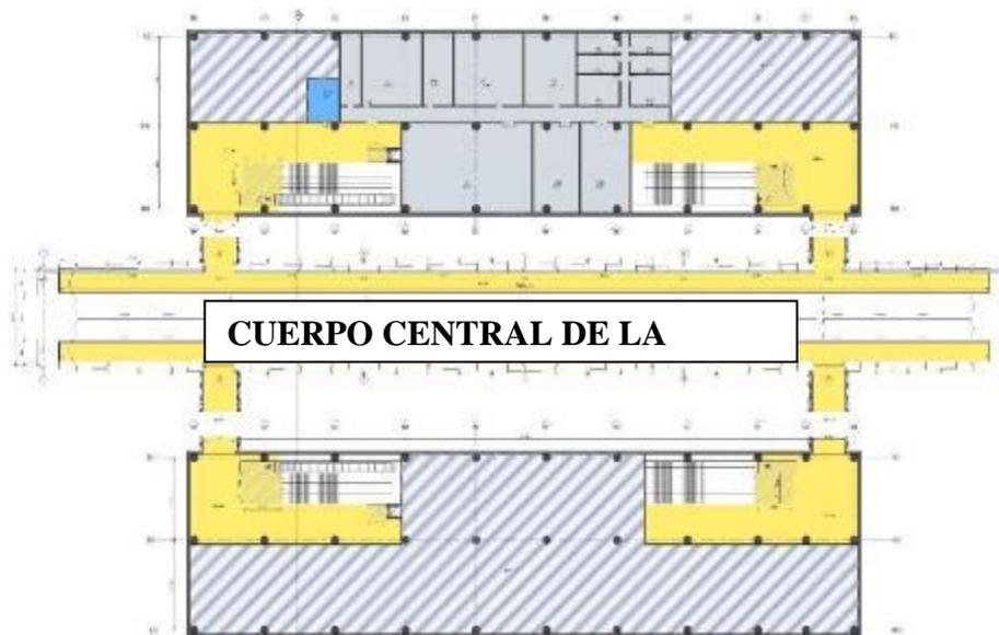
**Ilustración 74. Nivel 3 o nivel de andén de una estación sencilla Fuente: Elaboración propia**
