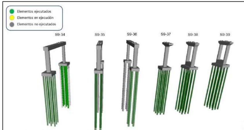
Figura 3.2.1.5.3-1. Esquema Subestructura viaducto UE-193(interestacion9).
