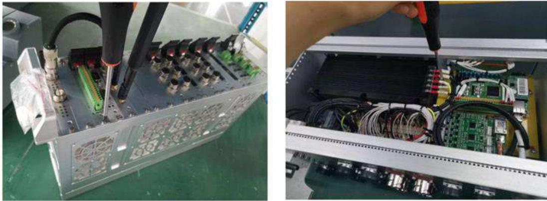
*Figura 3.2.1.6-1. Pruebas de manufactura internas a nivel de ensamblaje, visual y hardware equipos BRDE.*
