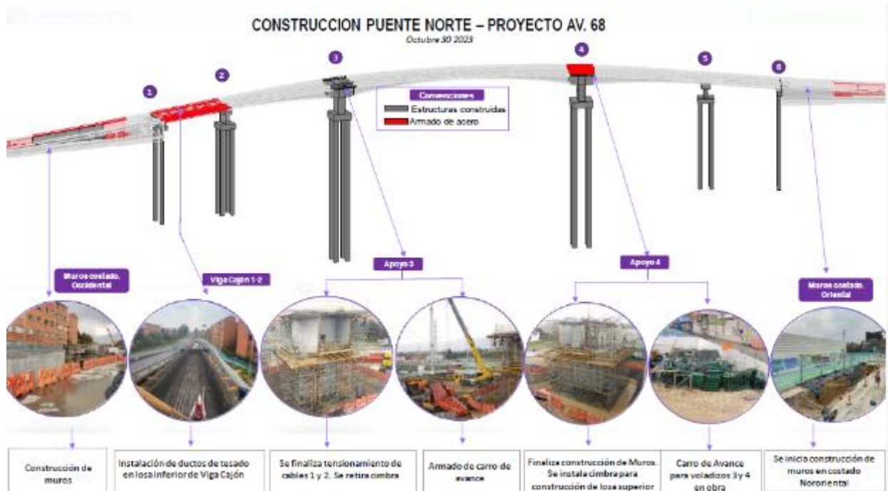
Figura 3.2.1.4-2. Esquema Isométrico de estructuras de cimentación (Pilotes, dados, pilas y estribos) Puente Norte AV. 68
