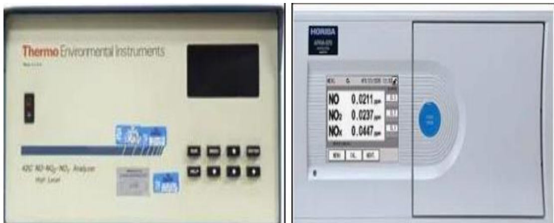
Fotografía 9. Equipo utilizado para las mediciones de NO 2
