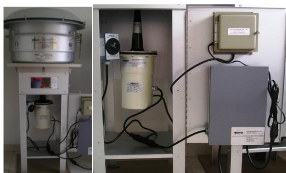
a) Cabezal con impactadores b) Shelter y cabezal c) Shelter con motor, horómetro, timer mecánico
