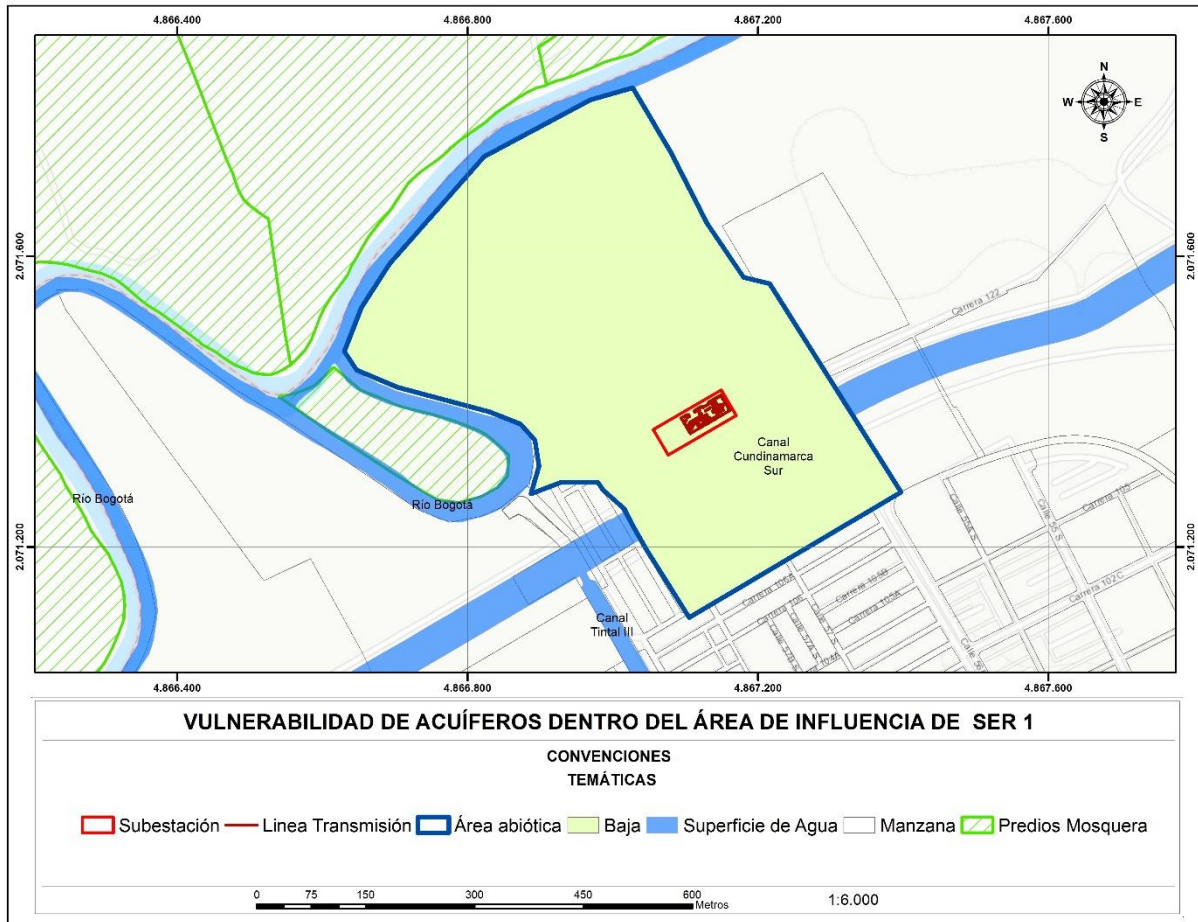
Figura 47. Vulnerabilidad a la contaminación de acuíferos en SER 1 (Método GOD)
