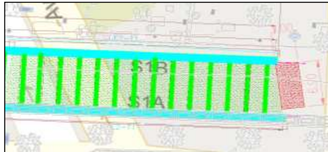
Ilustración k.ii.1.2-15. Avance losa de aproximación costado nororiental.
