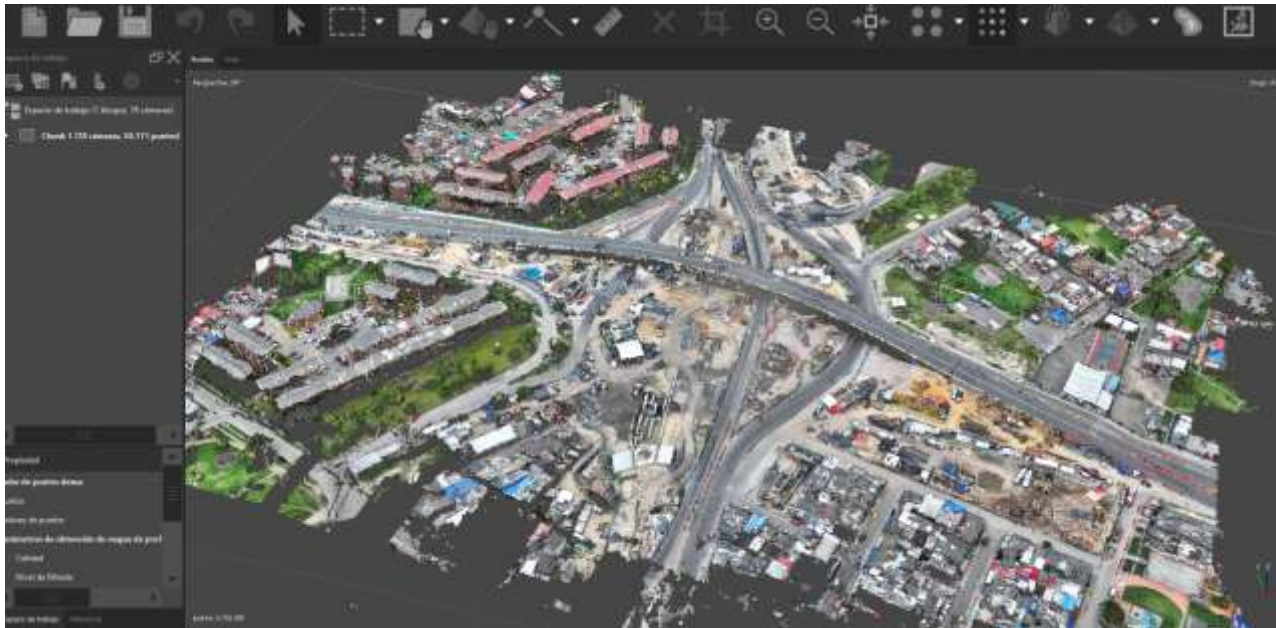
Ilustración k.ii.3.3-1. Nube de puntos Ptes Av 68 del 26 de febrero de 2025
