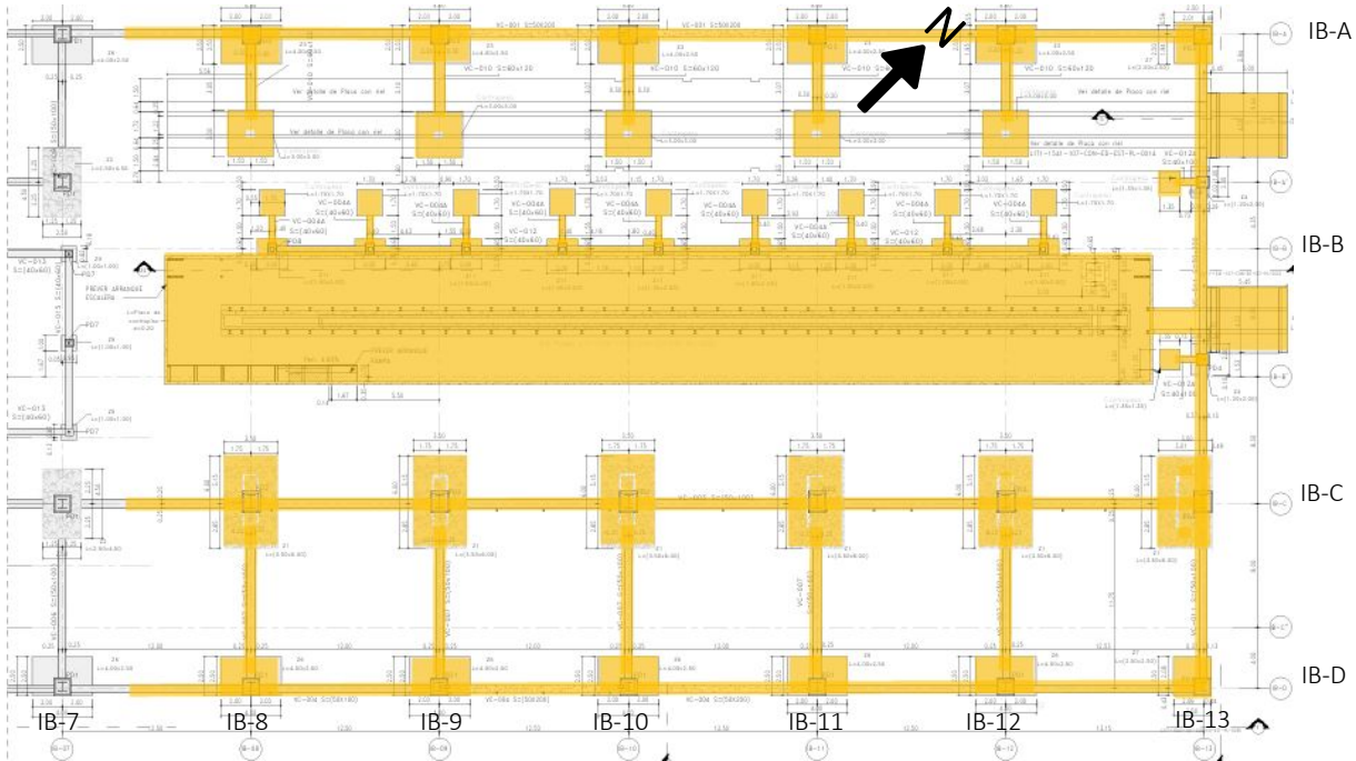
Figura a.2.1-23. Avance de actividades de excavación para cimentación Bloque B, Mantenimiento de infraestructura.
