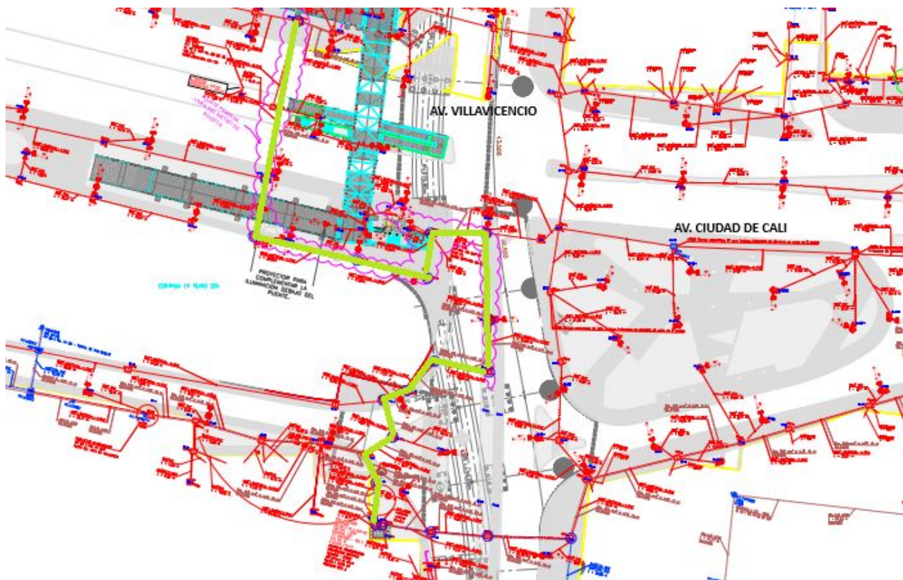
--- Trayectoria del circuito de media tensión trasladado. Ilustración a.2.5-3. Plano de seguimiento de la red eléctrica ENE2-18, ENE2-SM3 y ENE2-SM4. Fuente: Plano L1T1-6220-000-CON-ED-ELM-PL-0014_V00
