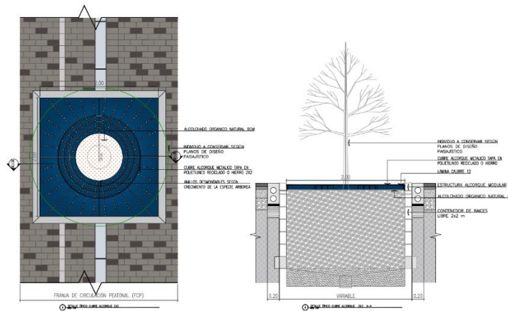
Figura 71 Alcorque metálico de 2,00 metros por 2,00 metros
