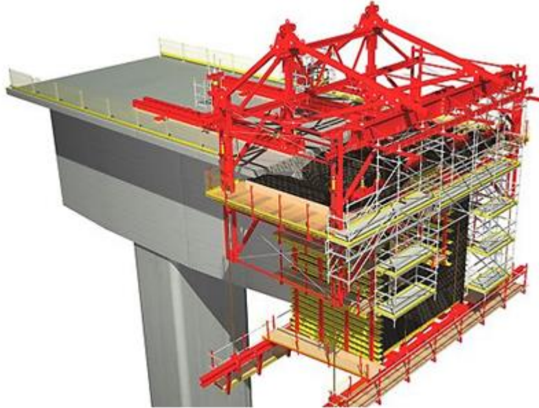
Figura 455 Construcción de dovelas
