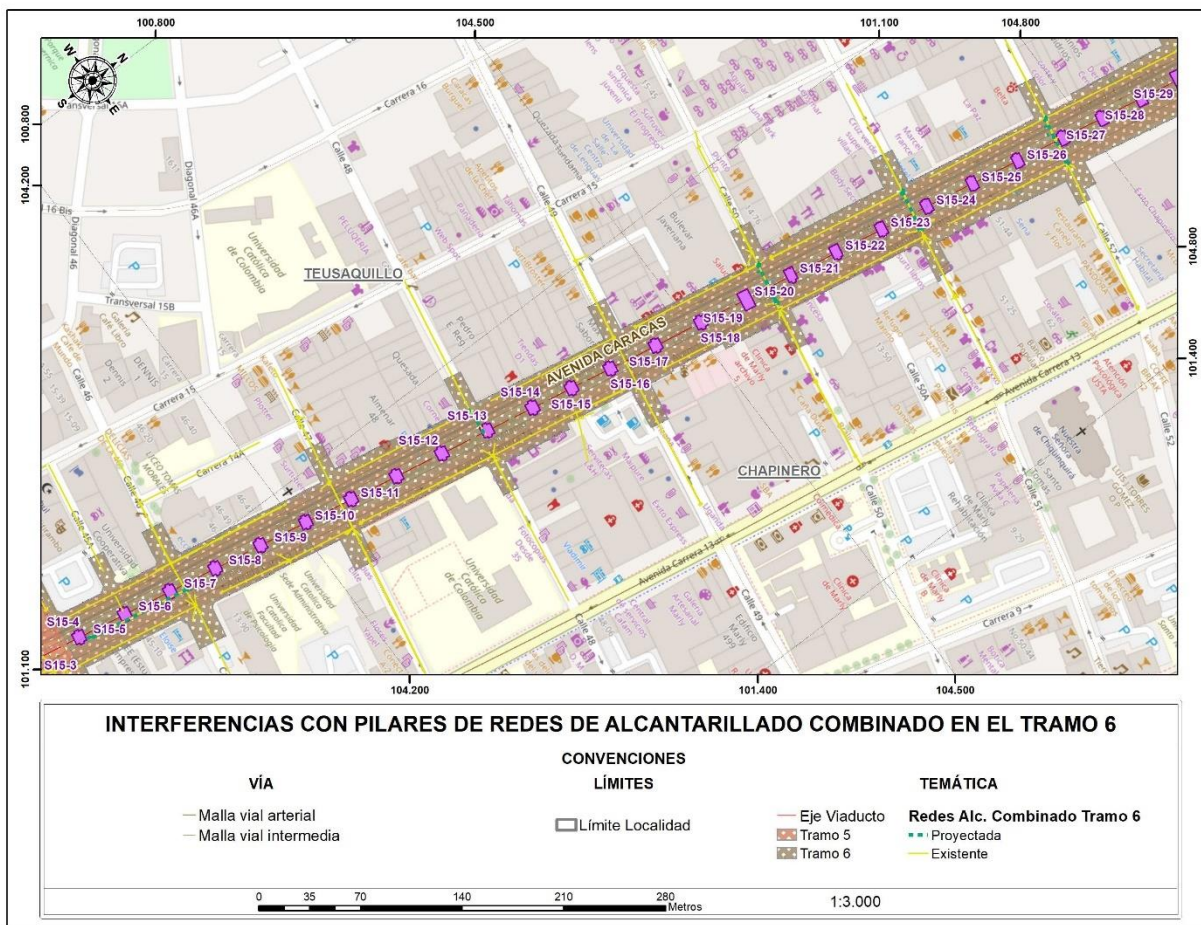
Figura 90 Interferencias con pilares de redes de Alcantarillado Combinado en el tramo 6
