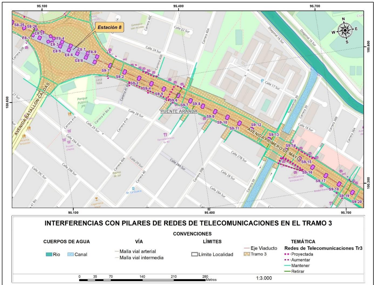
Figura 119 Interferencias con pilares de redes de Telecomunicaciones en el tramo 3
