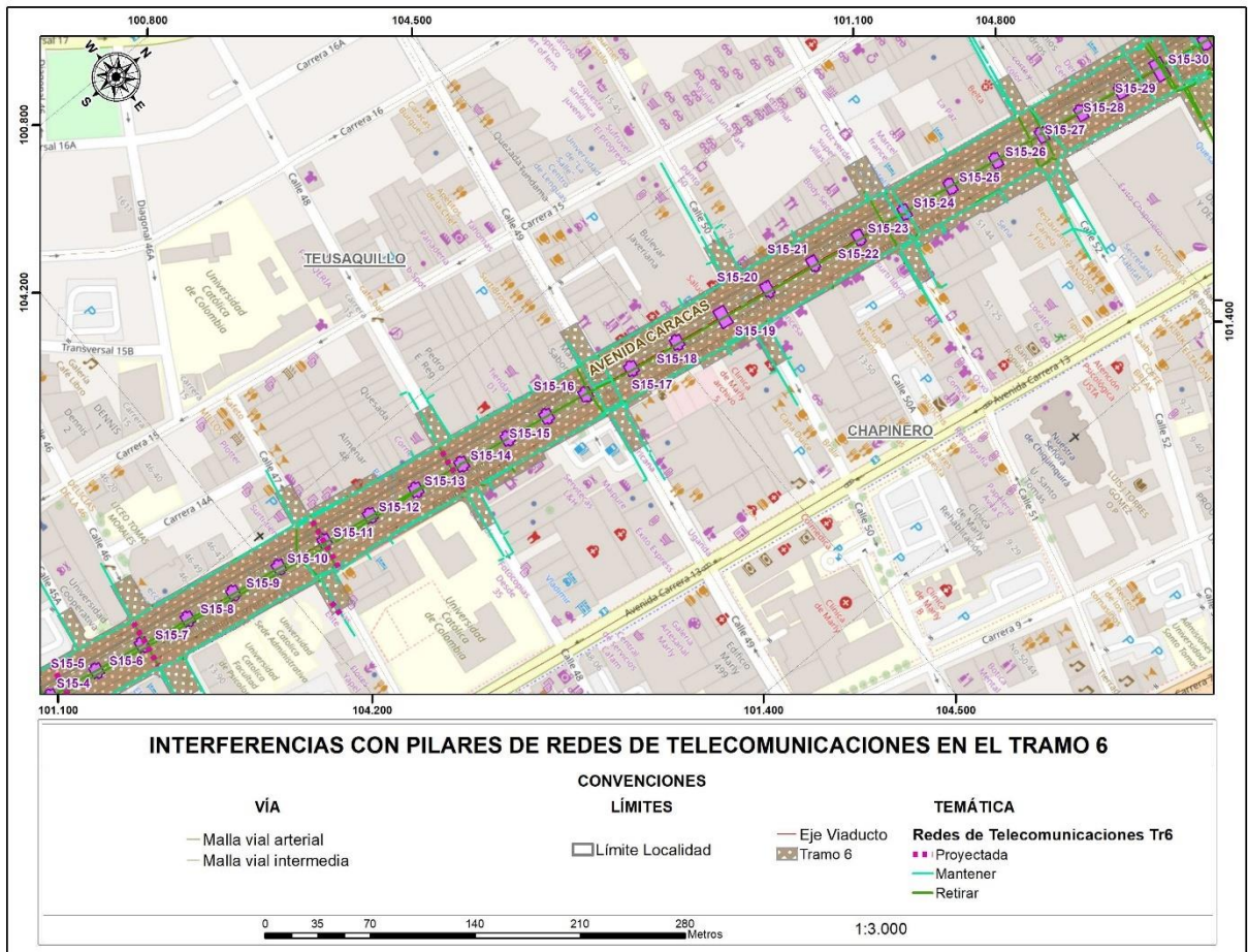
Figura 126 Interferencias con pilares de redes de Telecomunicaciones en el tramo 6
