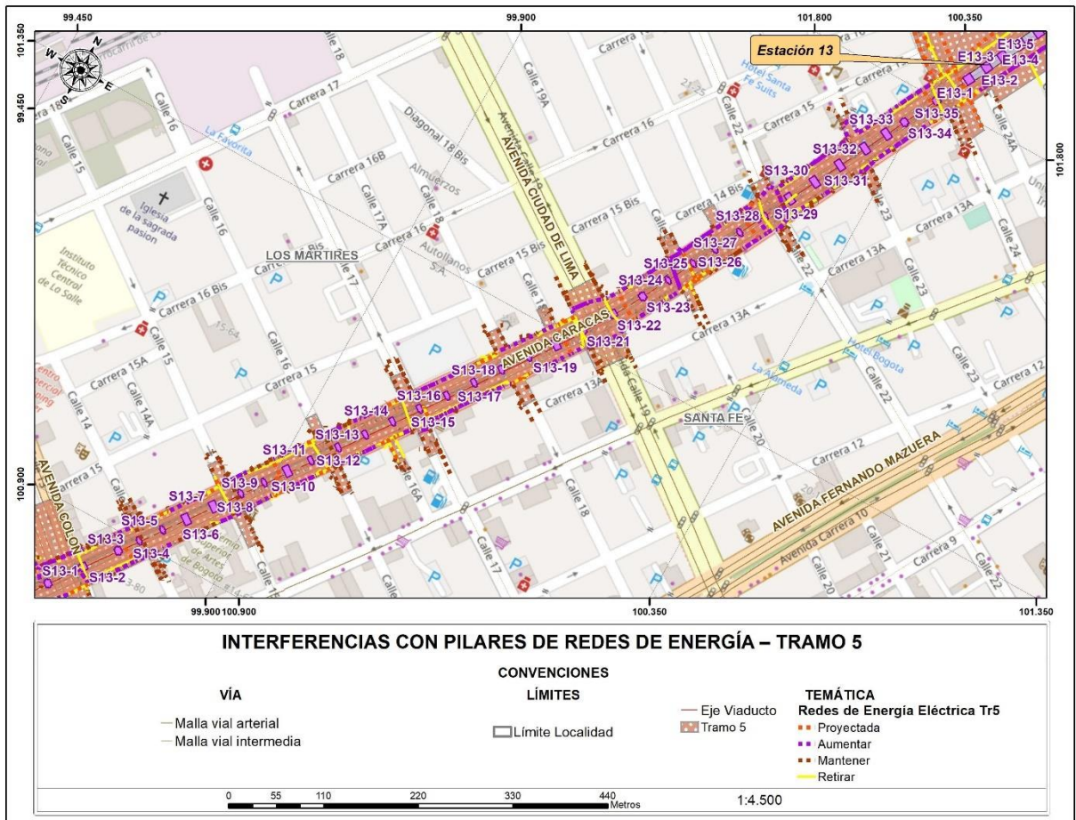
Figura 106 Interferencias con pilares de redes de Energía – tramo 5
