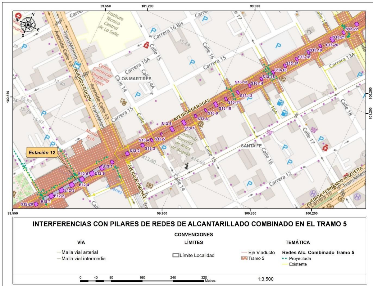
Figura 86 Interferencias con pilares de redes de Alcantarillado Combinado en el tramo 5
