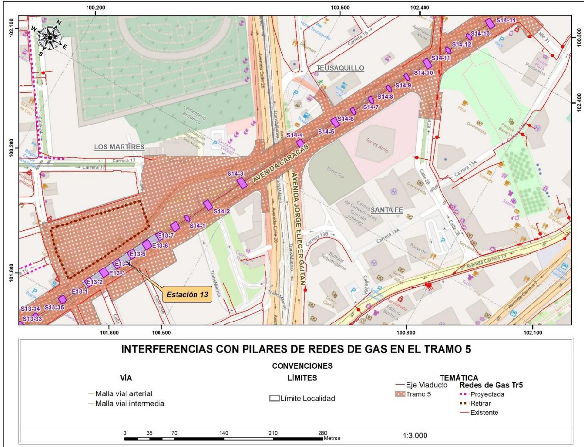
Figura 143 Interferencias con pilares de redes de Gas en el tramo 5
