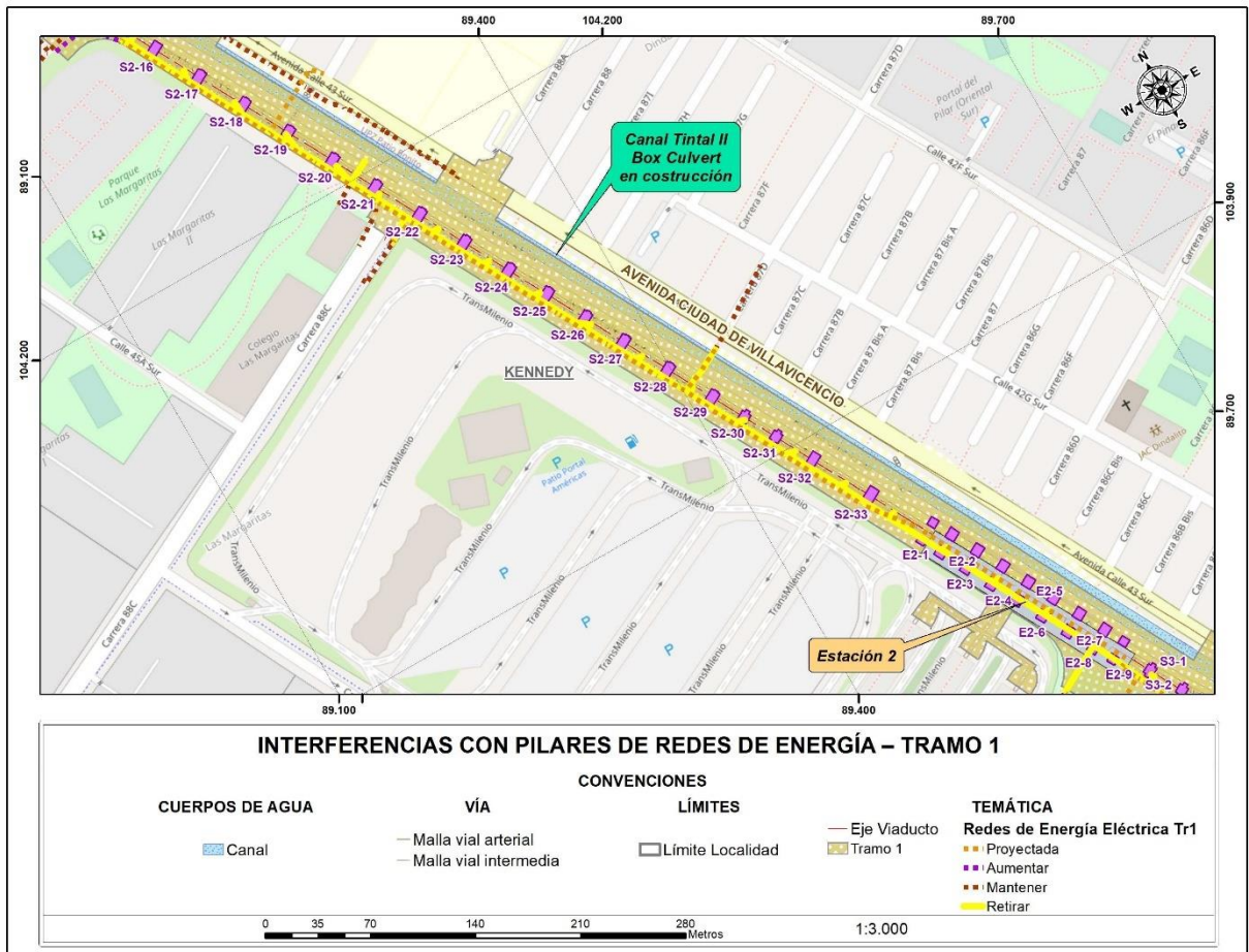
Figura 94 Interferencias con pilares de redes de Energía – tramo 1
