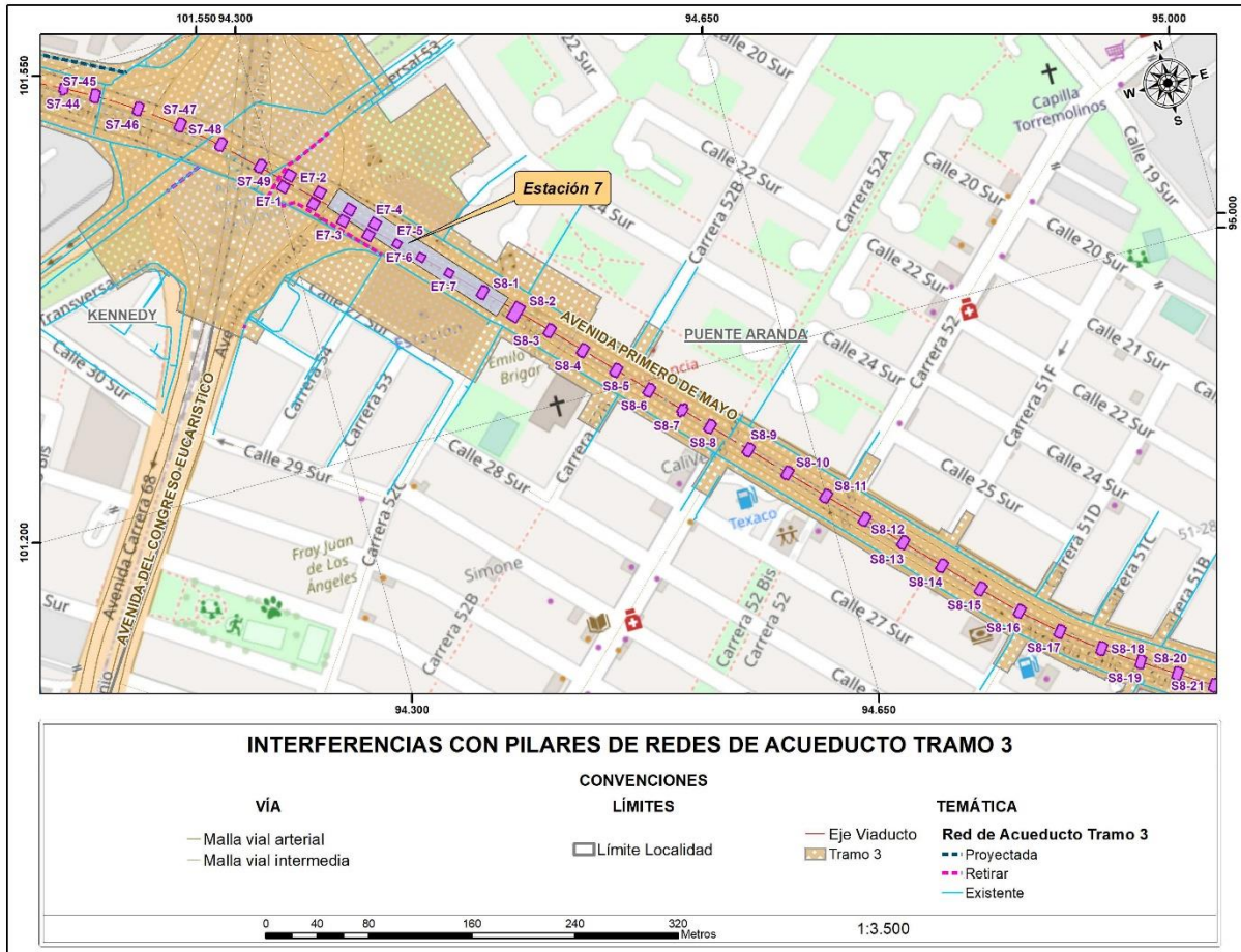
Figura 51 Interferencias con pilares de redes de Acueducto tramo 3
