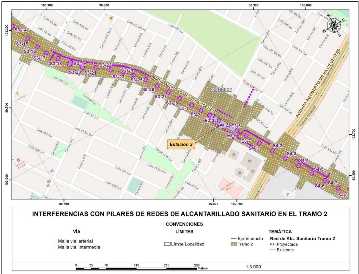
Figura 64 Interferencias con pilares de redes de Alcantarillado Sanitario en el tramo 2
