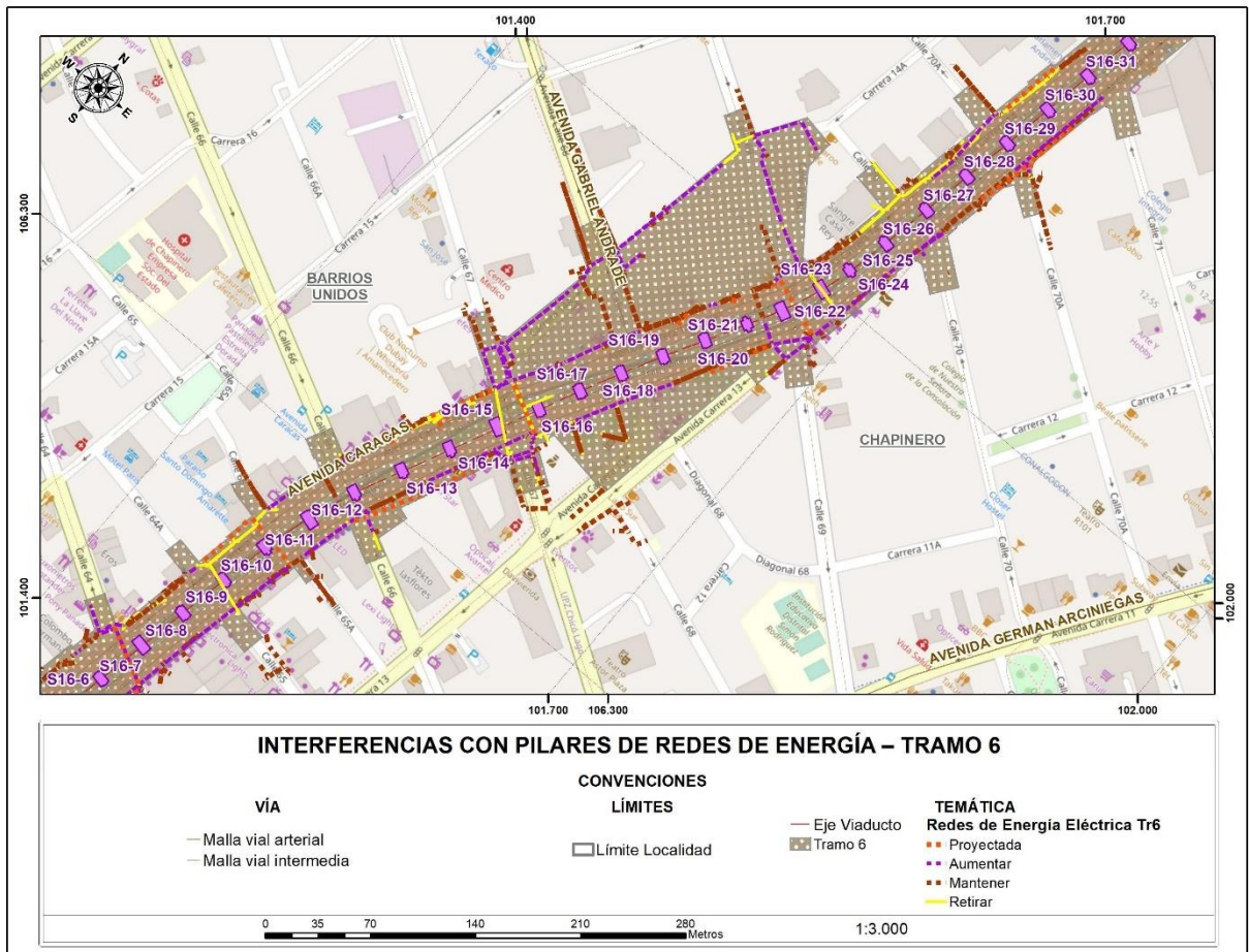
Figura 111 Interferencias con pilares de redes de Energía – tramo 6
