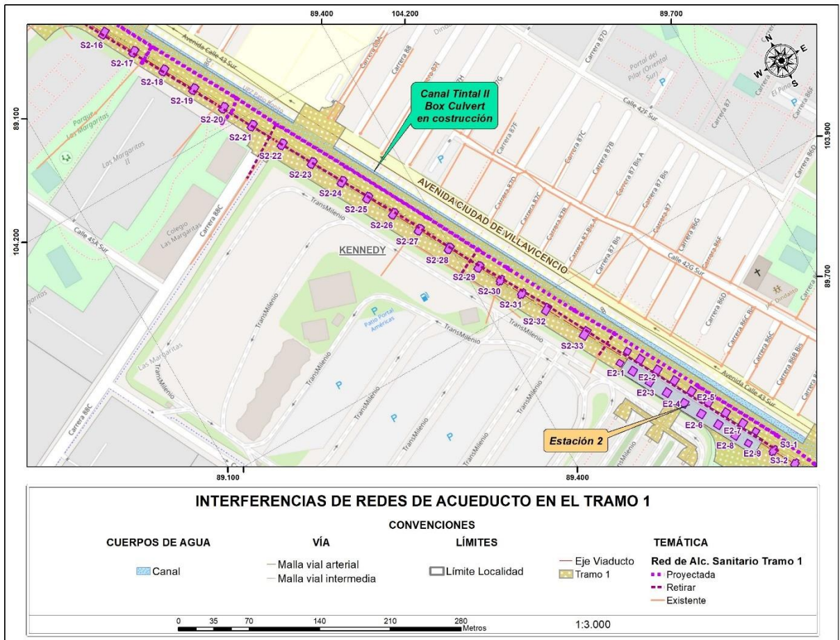
Figura 62 Interferencias con pilares de redes de Alcantarillado Sanitario en el tramo 1
