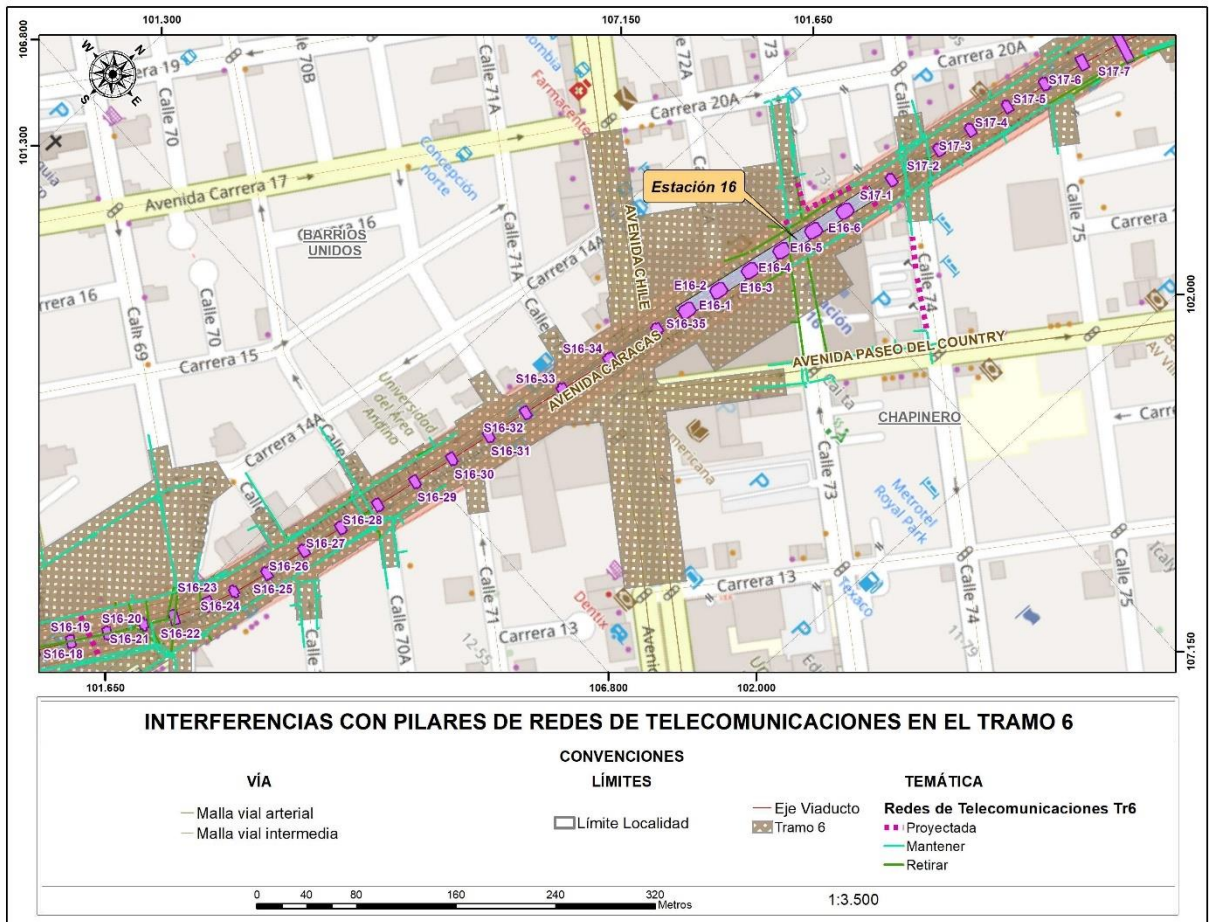
Figura 128 Interferencias con pilares de redes de Telecomunicaciones en el tramo 6
