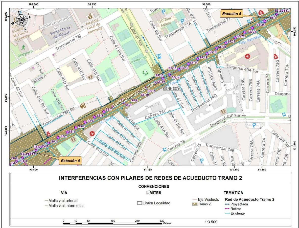
Figura 49 Interferencias con pilares de redes de Acueducto tramo 2
