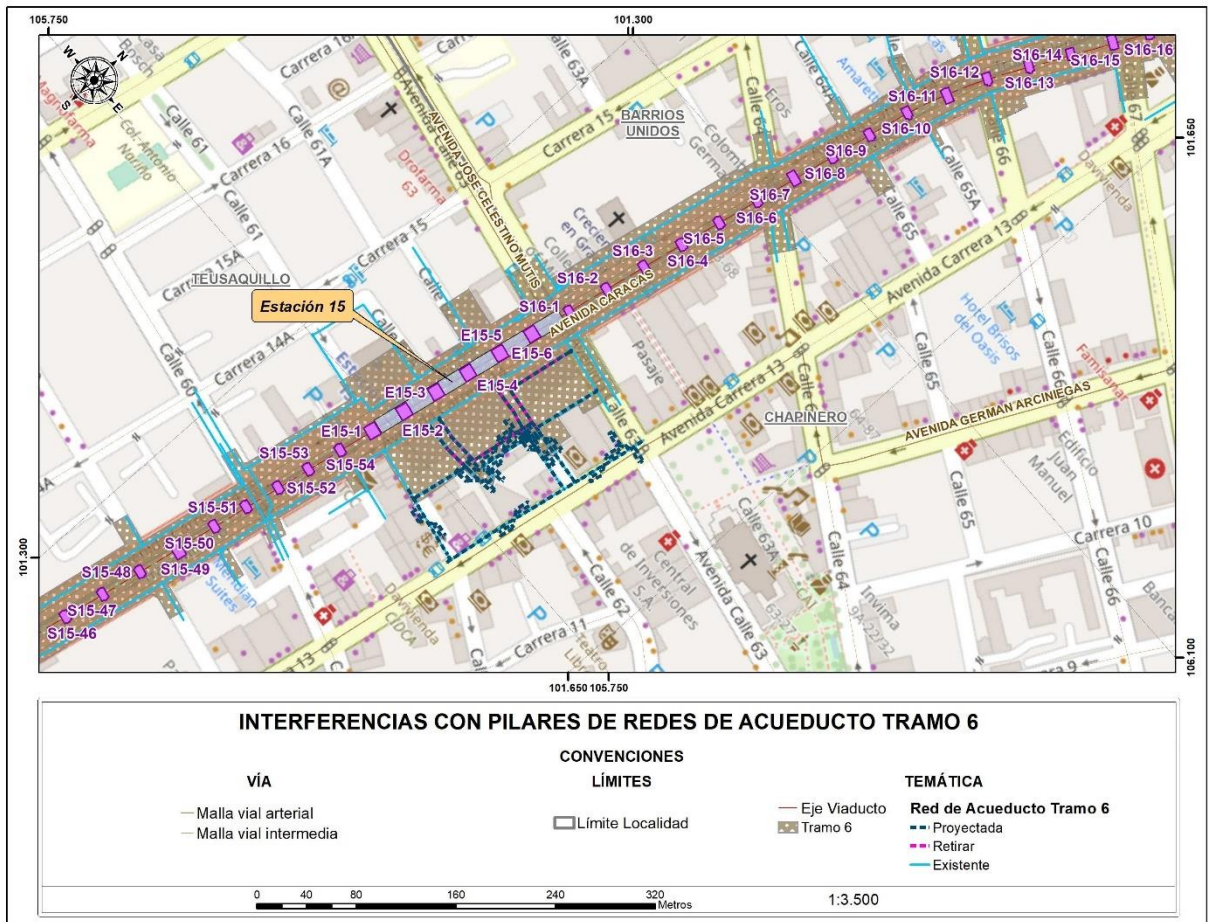
Figura 59 Interferencias con pilares de redes de Acueducto tramo 6
