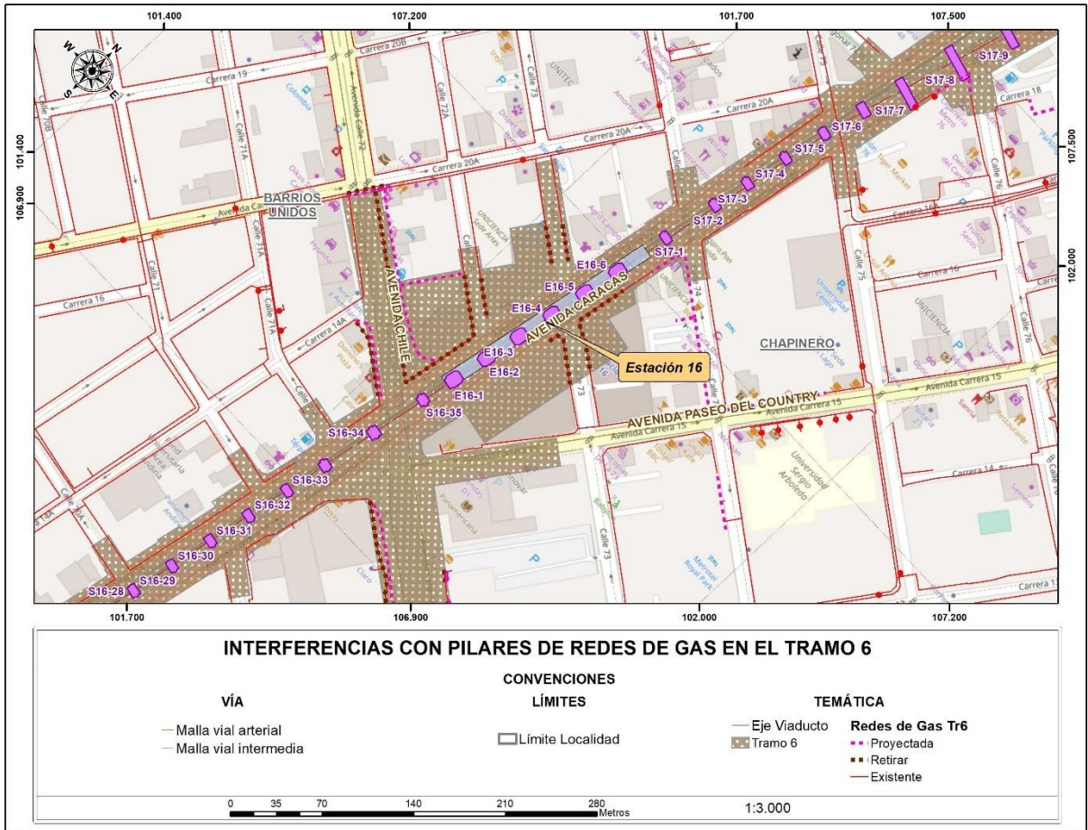
Figura 147 Interferencias con pilares de redes de Gas en el tramo 6
