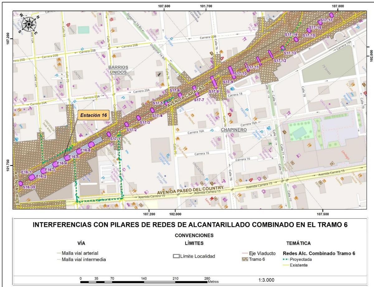
Figura 92 Interferencias con pilares de redes de Alcantarillado Combinado en el tramo 6
