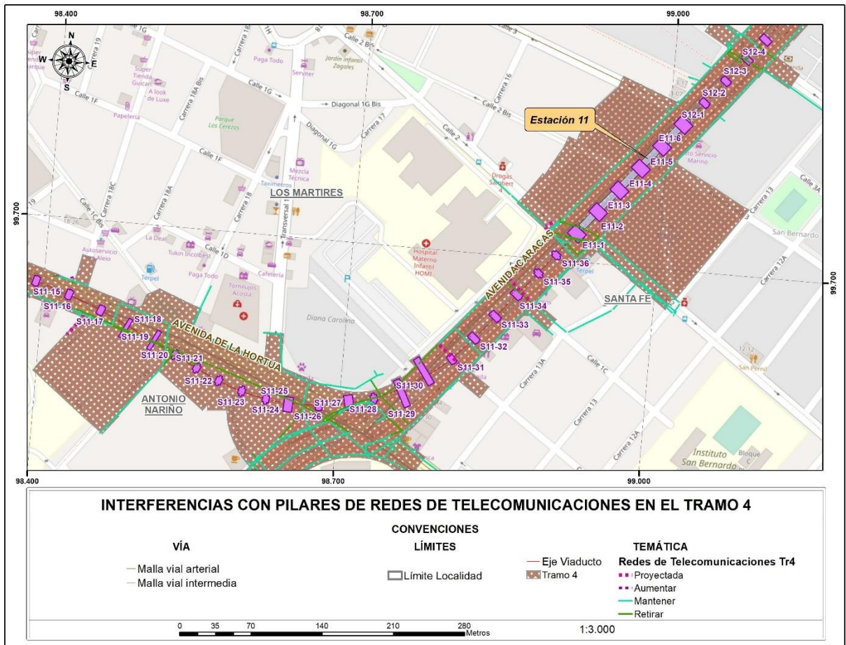
Figura 122 Interferencias con pilares de redes de Telecomunicaciones en el tramo 4
