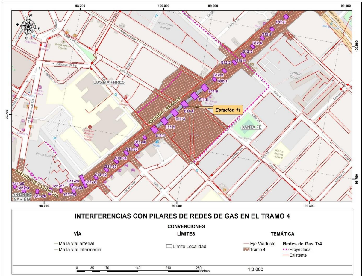
Figura 141 Interferencias con pilares de redes de Gas en el tramo 4
