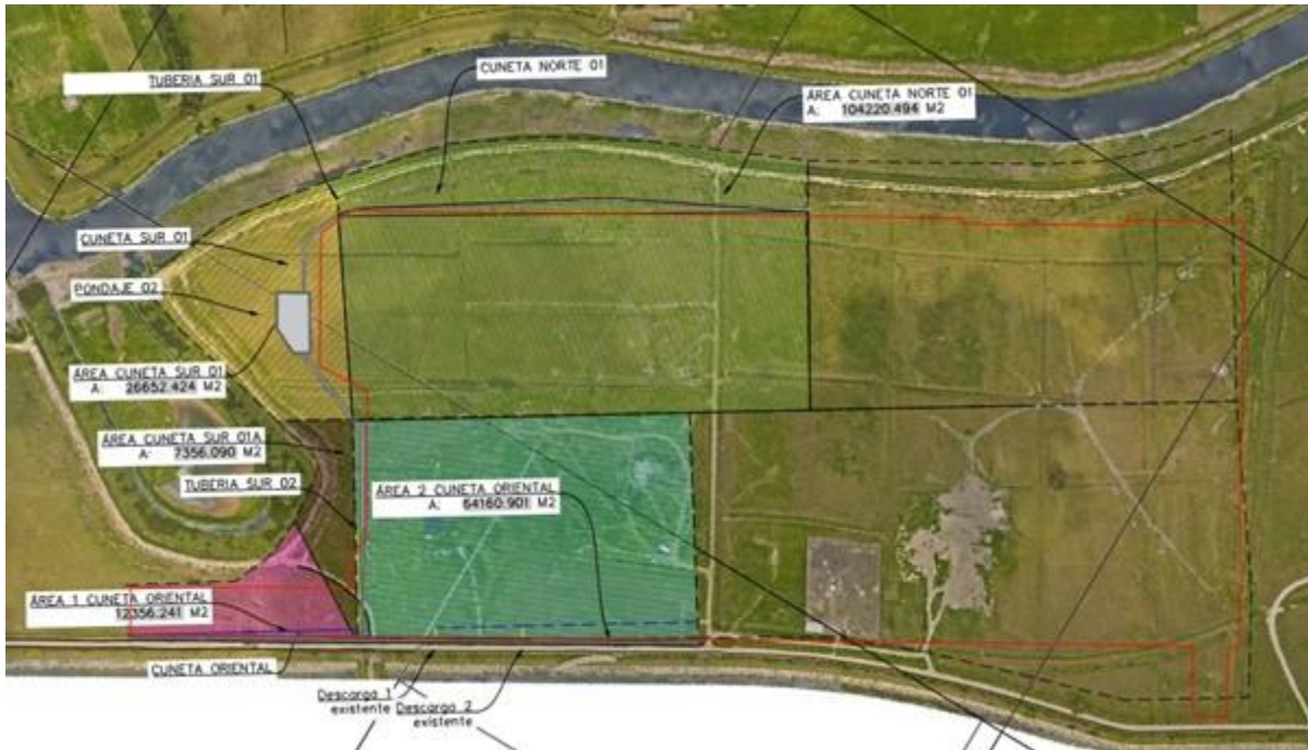
Figura 214 Concepto hidrológico del drenaje de la plataforma
