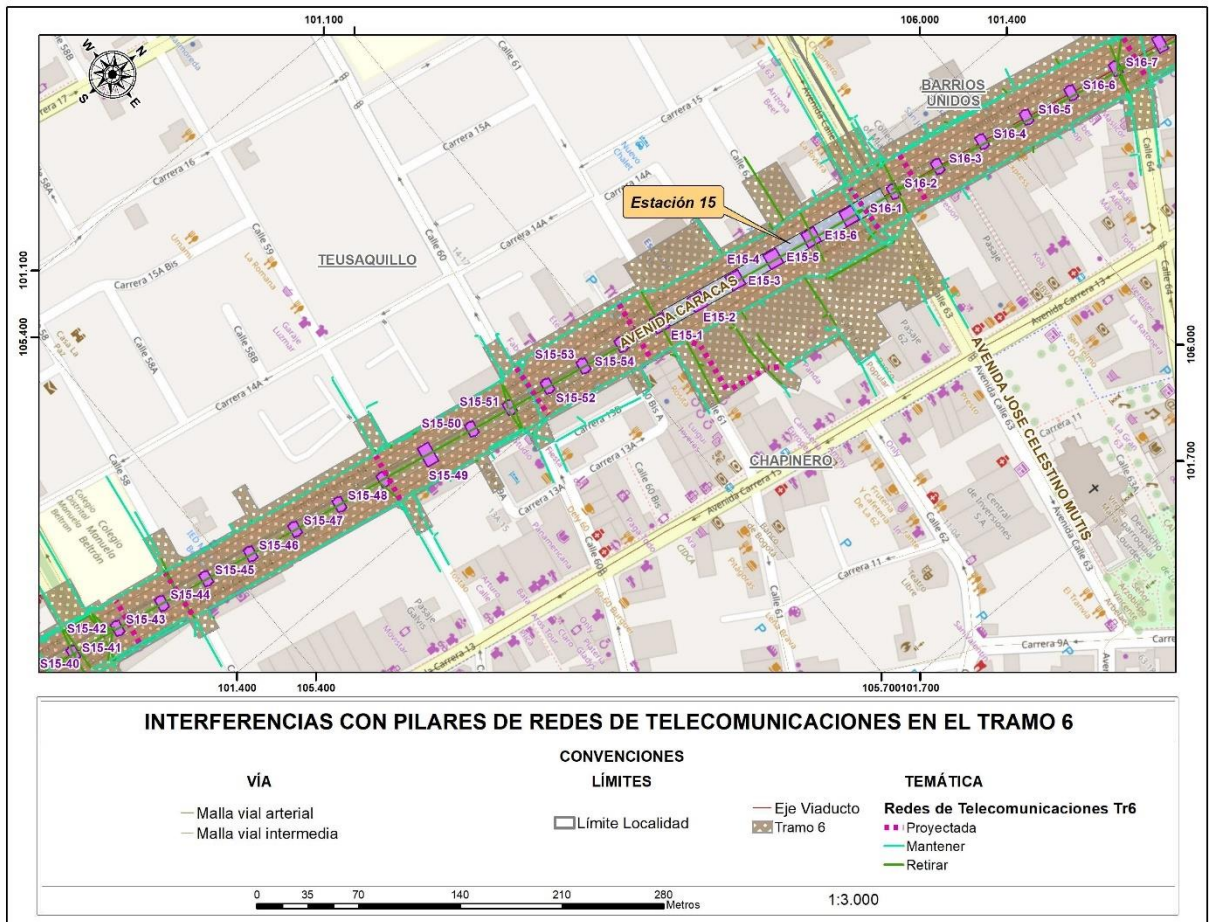
Figura 127 Interferencias con pilares de redes de Telecomunicaciones en el tramo 6
