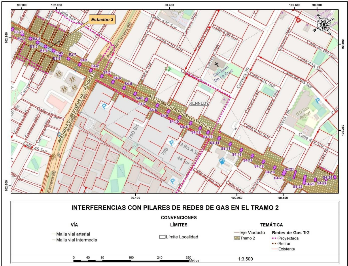
Figura 132 Interferencias con pilares de redes de Gas en el tramo 2
