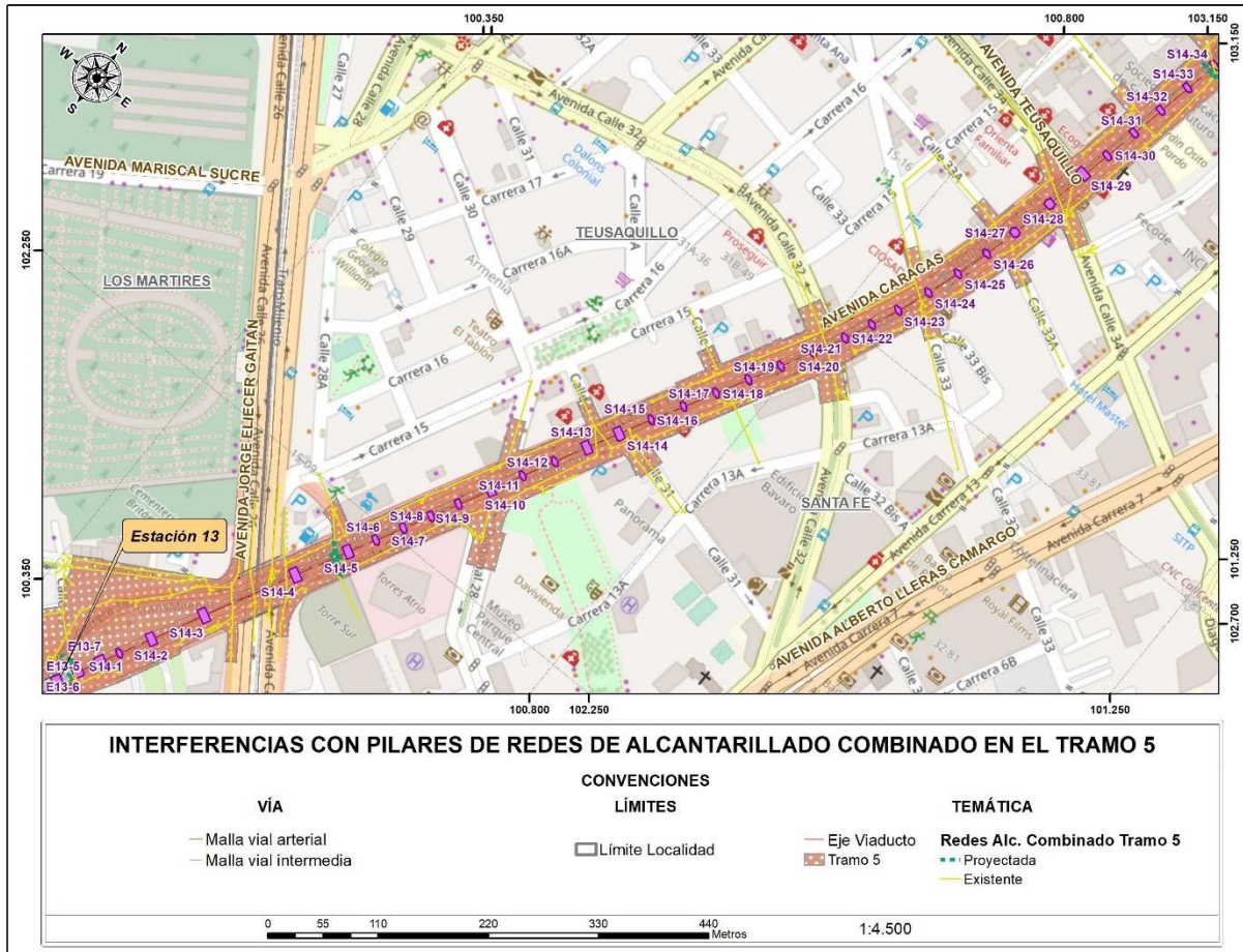
Figura 87 Interferencias con pilares de redes de Alcantarillado Combinado en el tramo 5
