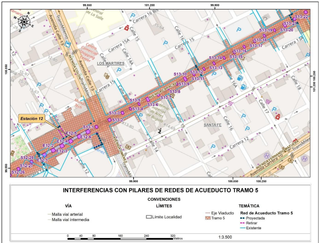
Figura 56 Interferencias con pilares de redes de Acueducto tramo 5
