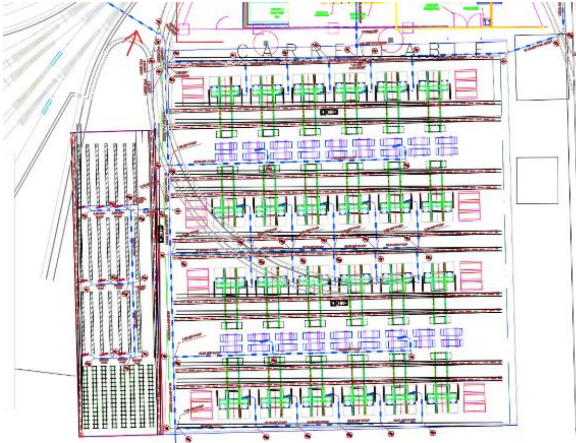
Figura 287 Esquemas puntos de distribución de agua dentro de planta de fabricación de vigas u
