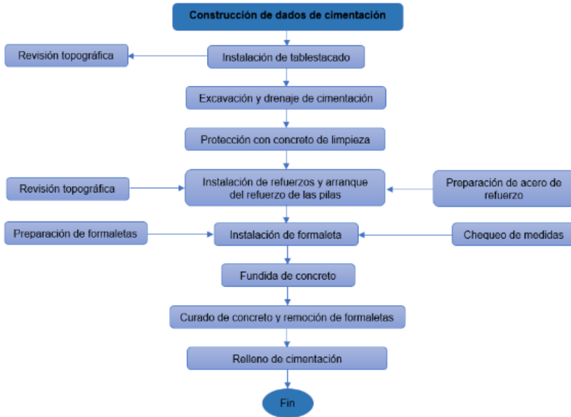
Figura 175 Proceso de construcción dados de cimentación
