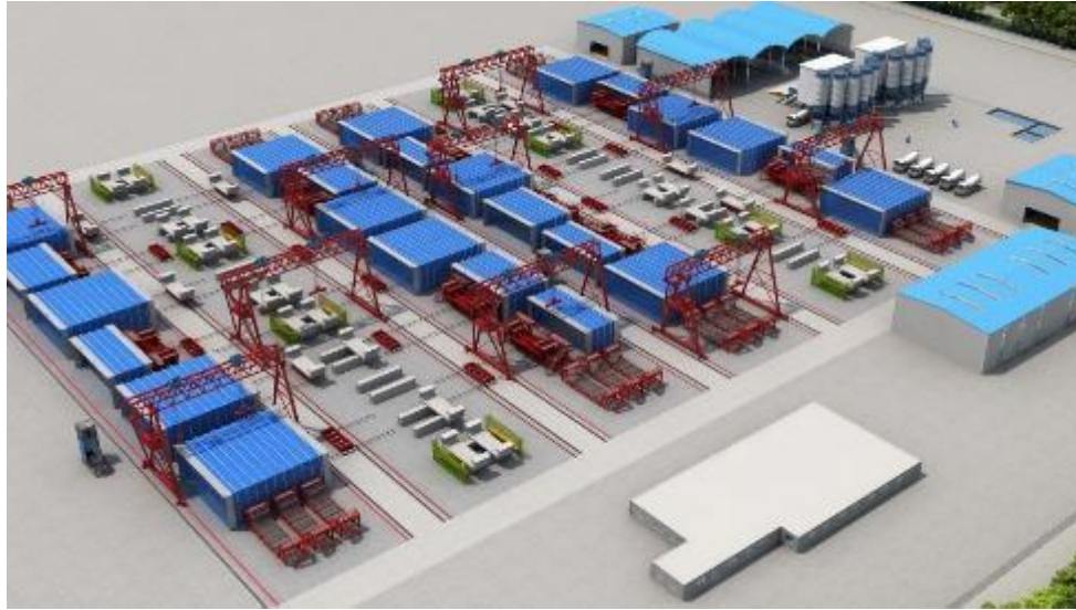
Figura 239 Patio de Vigas U prefabricadas
