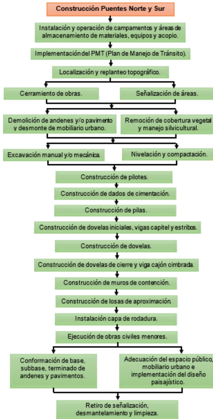
Figura 435 Actividades para la construcción de los puentes de la Av. Primero de Mayo con Av.68
