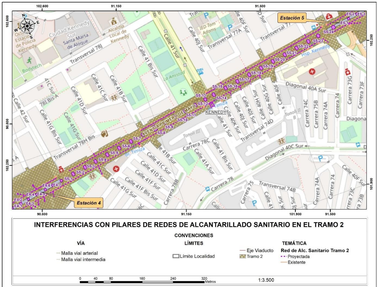
Figura 65 Interferencias con pilares de redes de Alcantarillado Sanitario en el tramo 2
