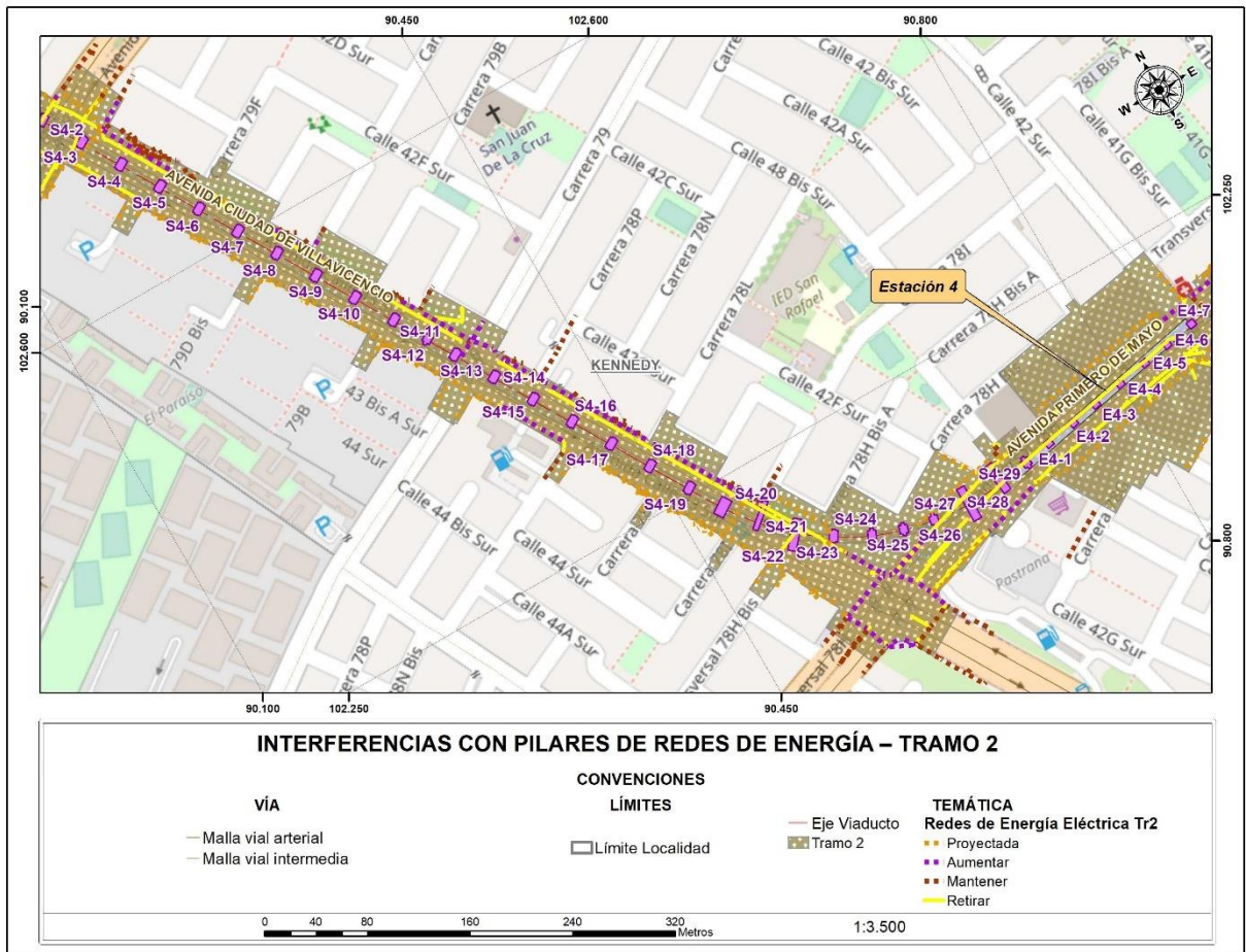
Figura 97 Interferencias con pilares de redes de Energía – tramo 2
