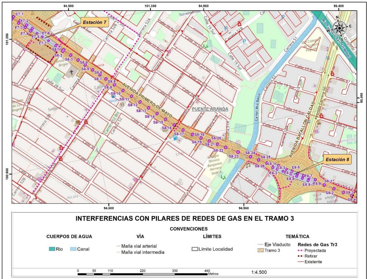
Figura 136 Interferencias con pilares de redes de Gas en el tramo 3
