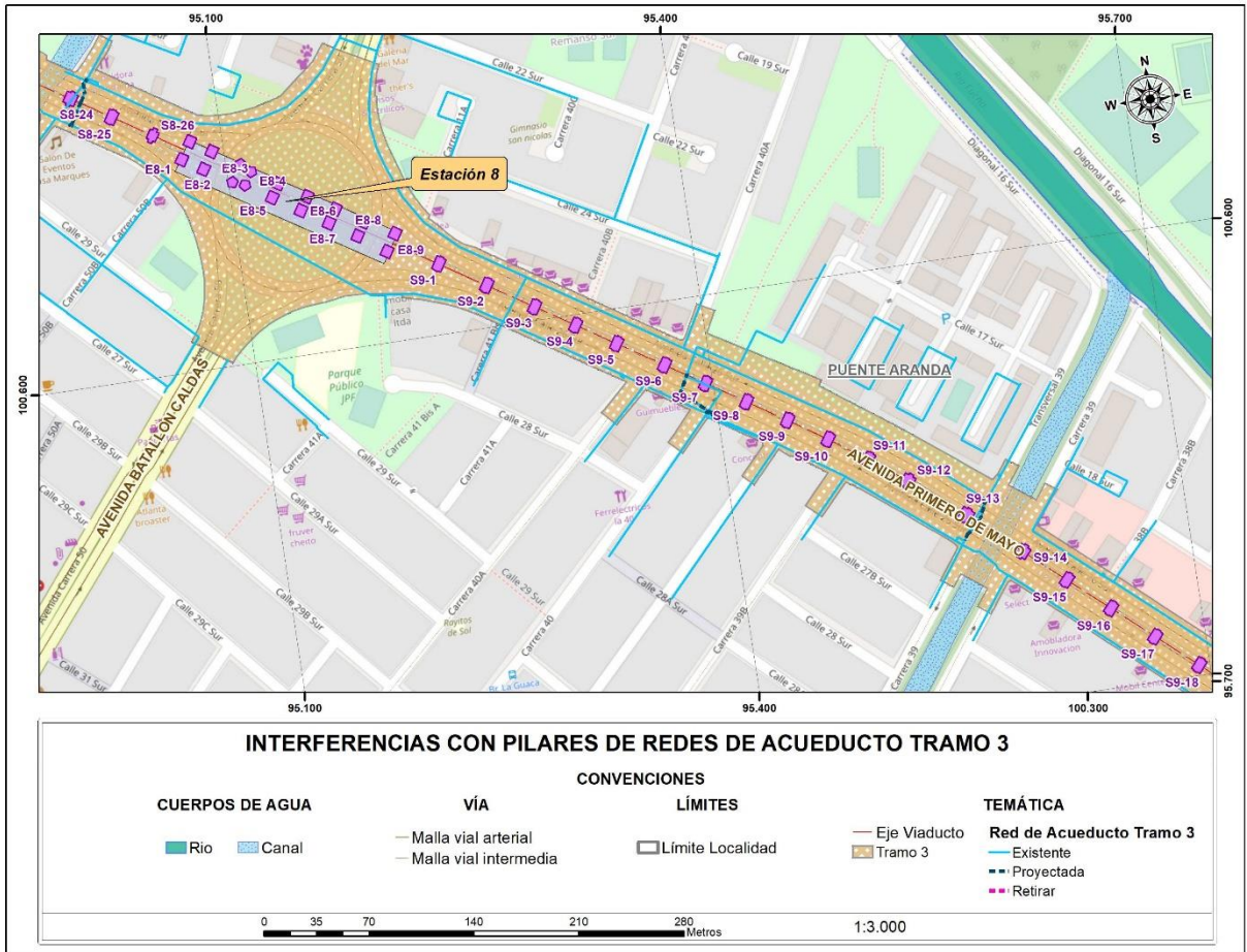
Figura 52 Interferencias con pilares de redes de Acueducto tramo 3
