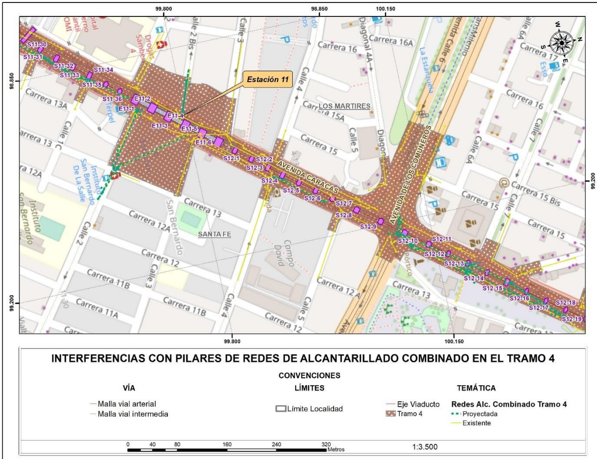
Figura 84 Interferencias con pilares de redes de Alcantarillado Combinado en el tramo 4
