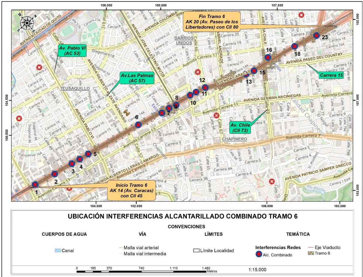
Figura 89 Ubicación interferencias alcantarillado combinado tramo 6
