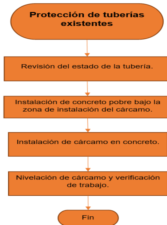
Figura 161 Diagrama Protección de tuberías existentes
