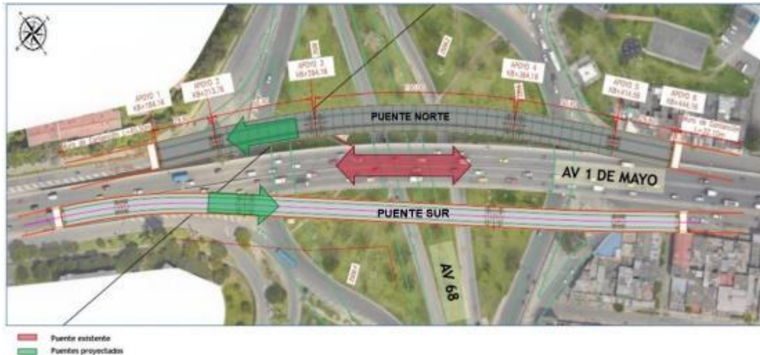
Figura 432 Esquema puente vehicular existente, puentes vehiculares proyectados
