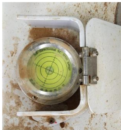
Fotografía 10 Instrumento de nivel de la piloteadora
