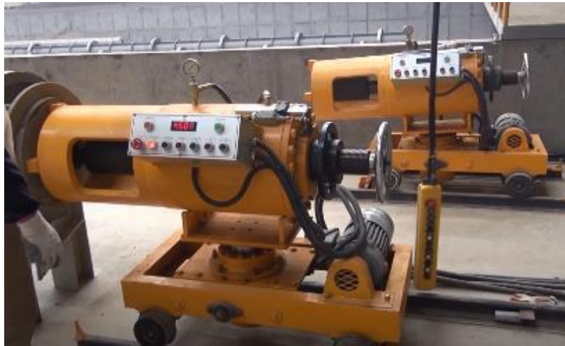
Fotografía 41 Sistema de pretensado
