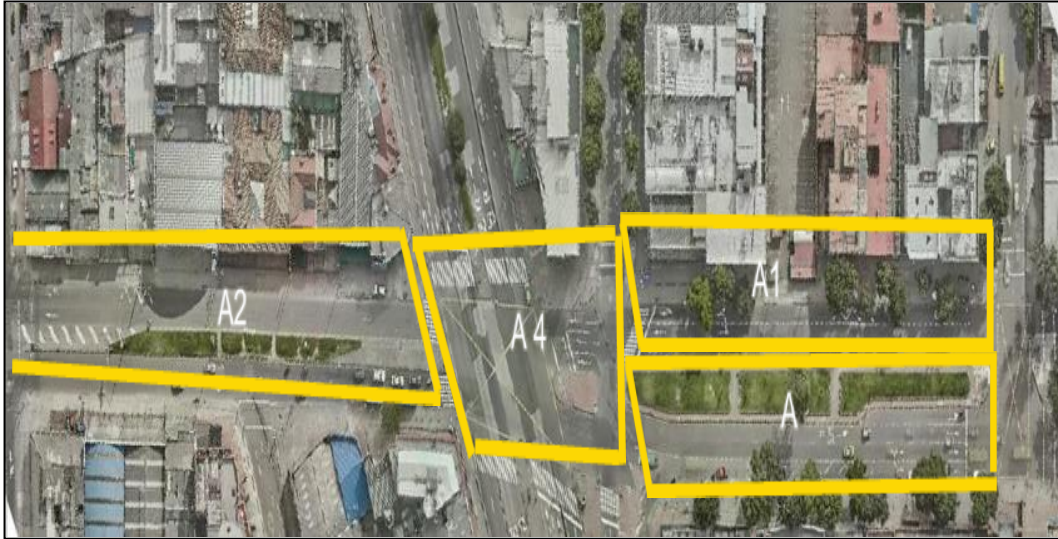
Figura 386 Fases de trabajo traslado de redes, calle 72
