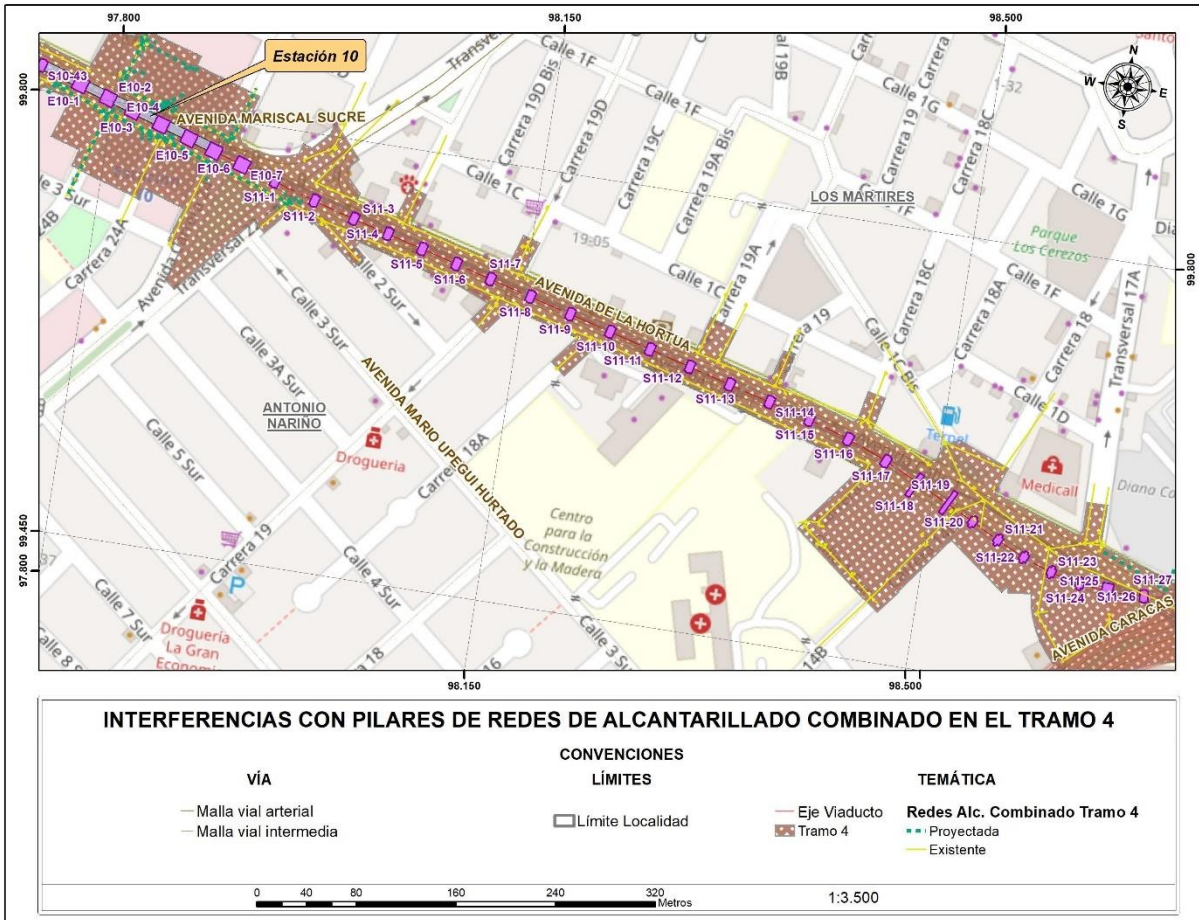
Figura 83 Interferencias con pilares de redes de Alcantarillado Combinado en el tramo 4
