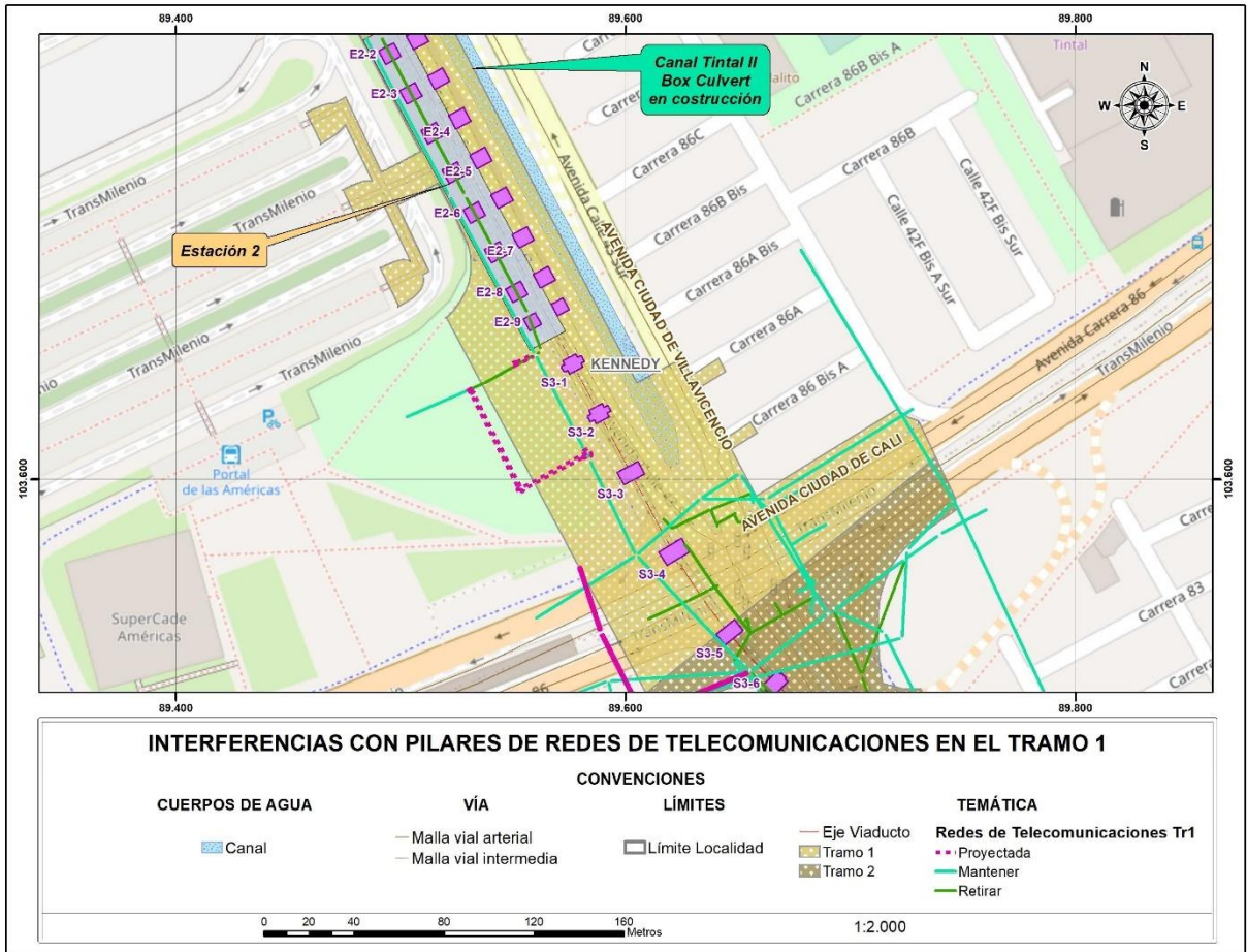
Figura 114 Interferencias con pilares de redes de Telecomunicaciones en el tramo 1
