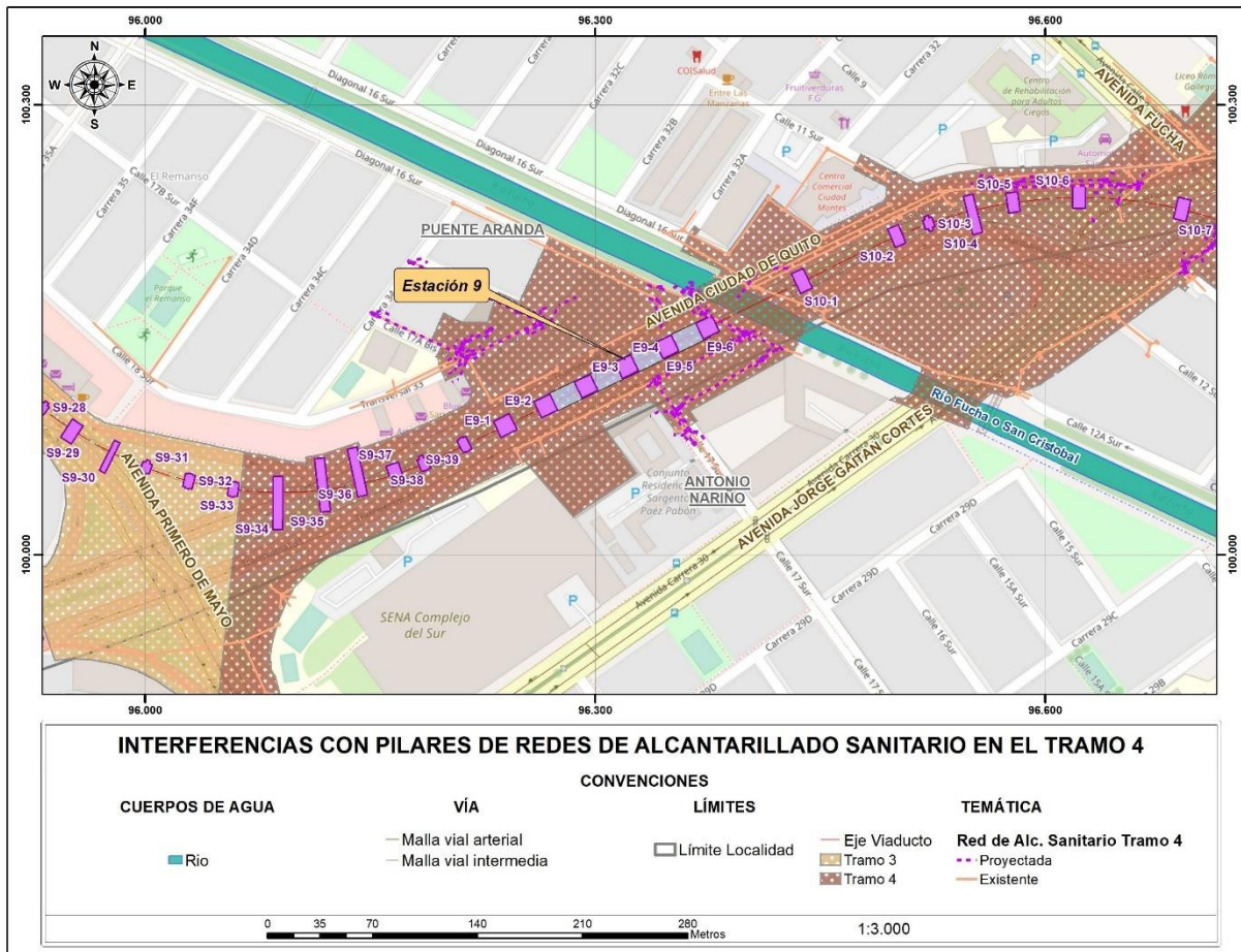
Figura 70 Interferencias con pilares de redes de Alcantarillado Sanitario en el tramo 4
