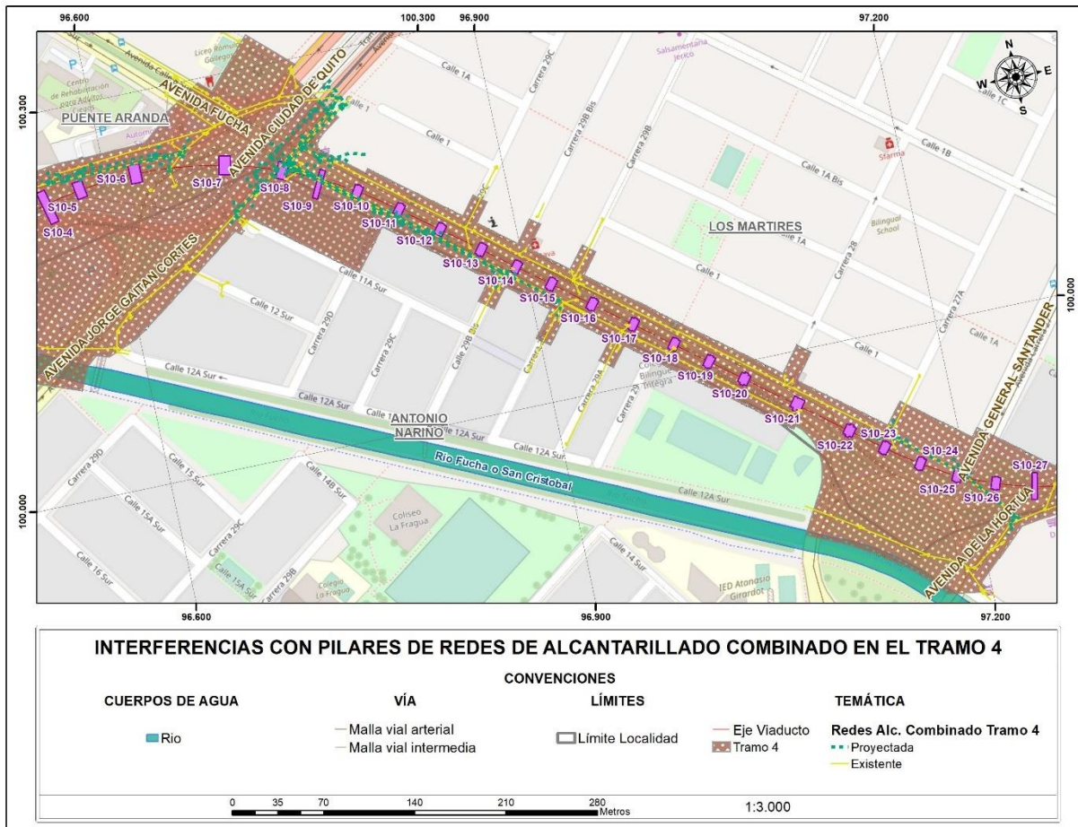
Figura 82 Interferencias con pilares de redes de Alcantarillado Combinado en el tramo 4
