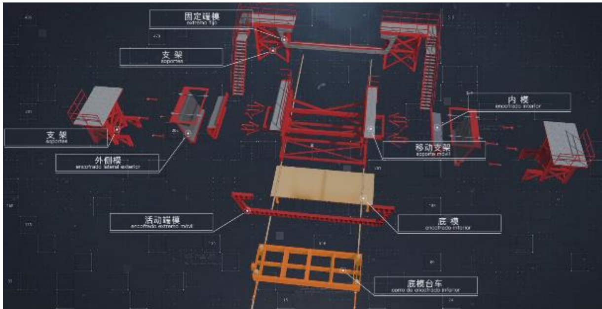
Figura 277 Sistema de encofrado
