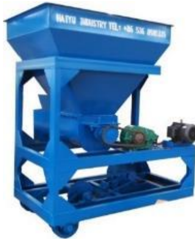
Fotografía 40 Sistema de alimentación de concreto
