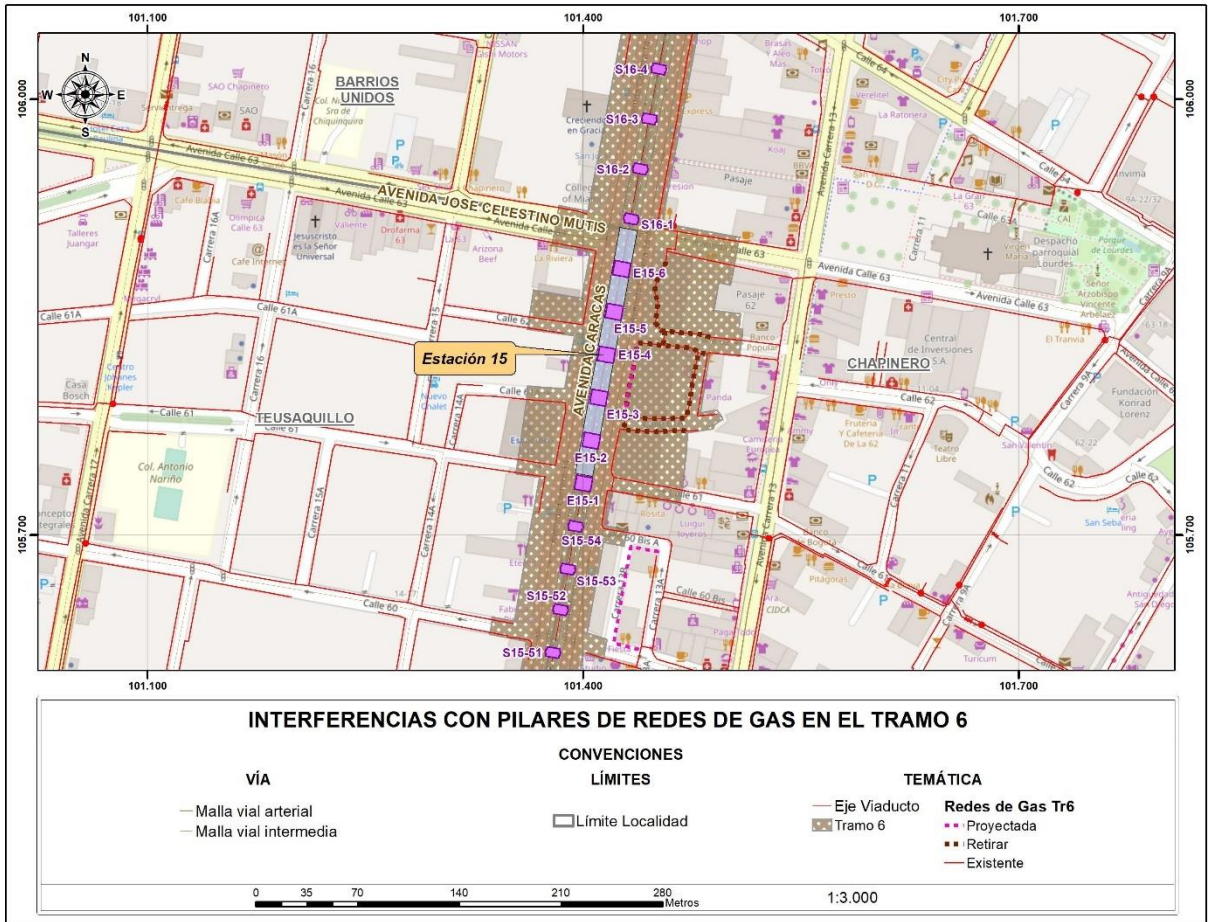
Figura 146 Interferencias con pilares de redes de Gas en el tramo 6
