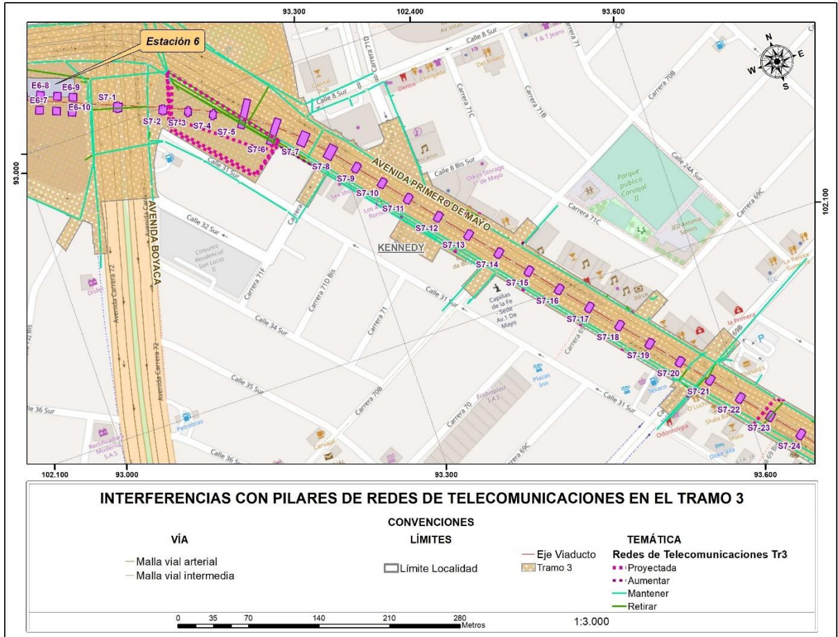
Figura 118 Interferencias con pilares de redes de Telecomunicaciones en el tramo 3
