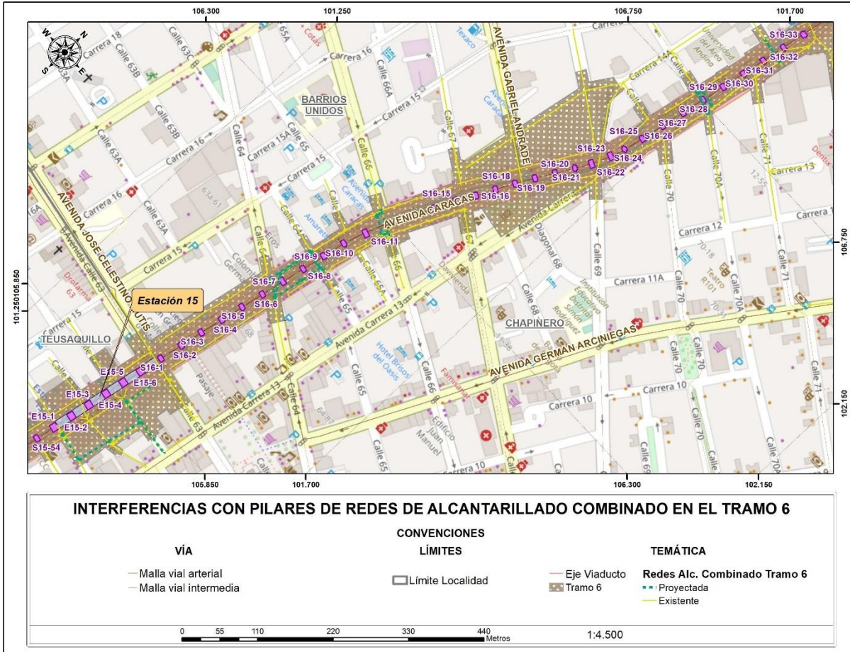
Figura 91 Interferencias con pilares de redes de Alcantarillado Combinado en el tramo 6
