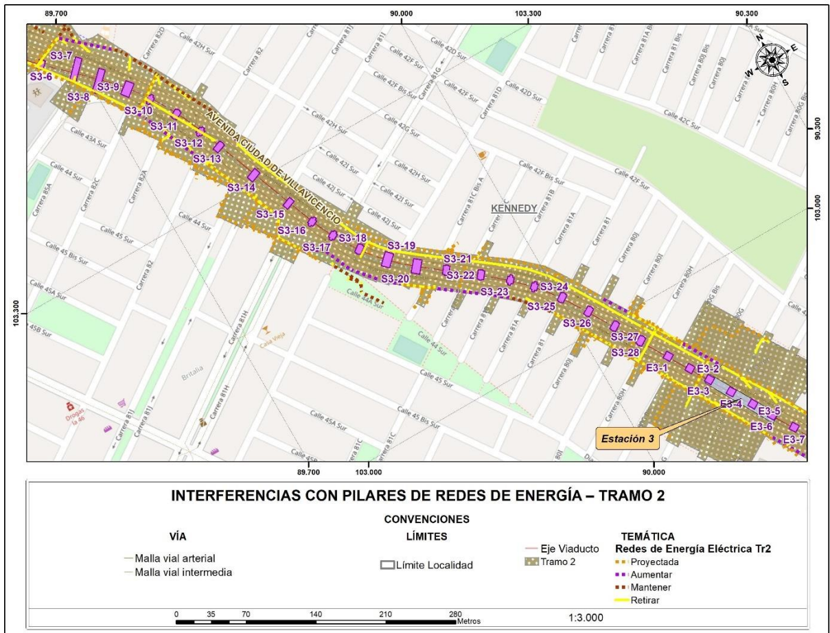
Figura 96 Interferencias con pilares de redes de Energía – tramo 2
