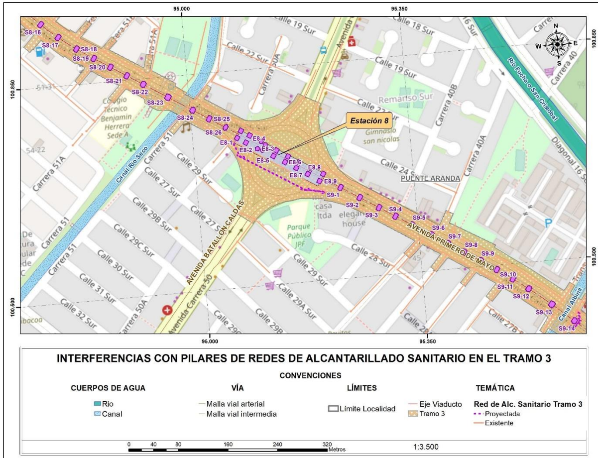
Figura 68 Interferencias con pilares de redes de Alcantarillado Sanitario en el tramo 3
