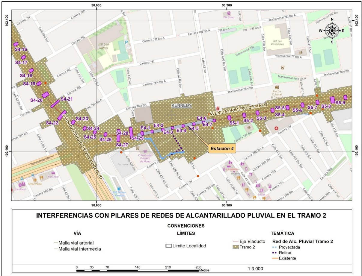
Figura 73 Interferencias con pilares de redes de Alcantarillado Pluvial en el tramo 2
