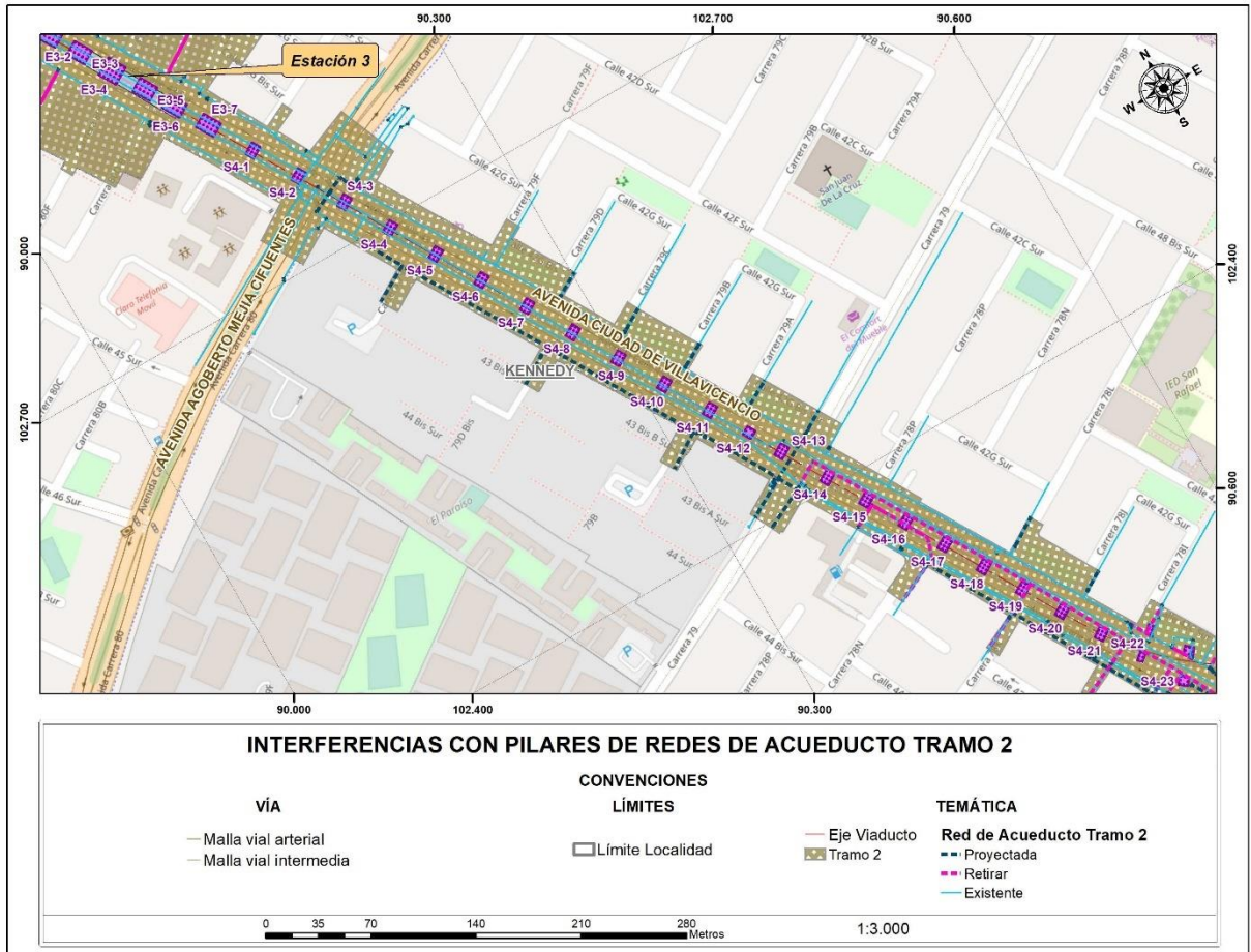
Figura 48 Interferencias con pilares de redes de Acueducto tramo 2
