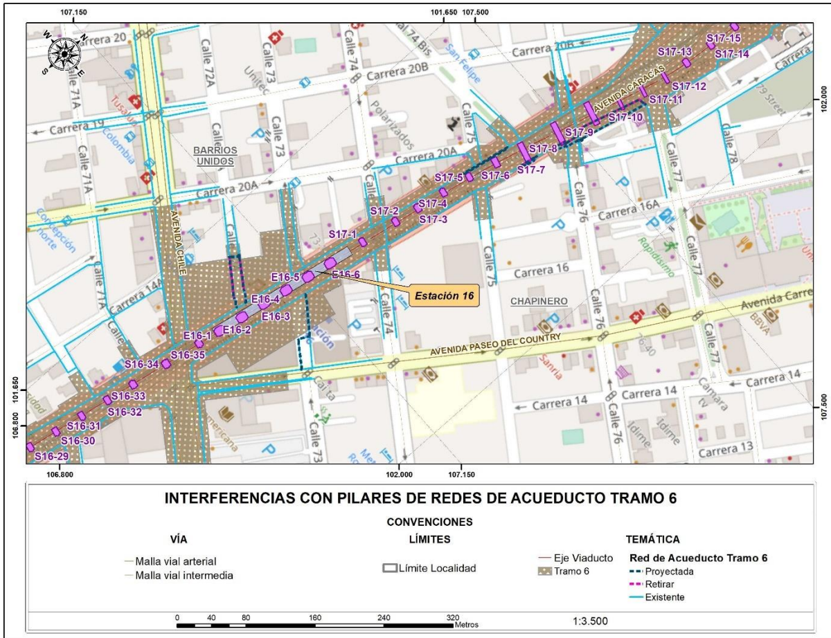
Figura 60 Interferencias con pilares de redes de Acueducto tramo 6
