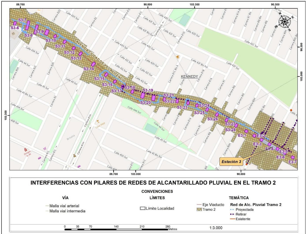
Figura 72 Interferencias con pilares de redes de Alcantarillado Pluvial en el tramo 2
