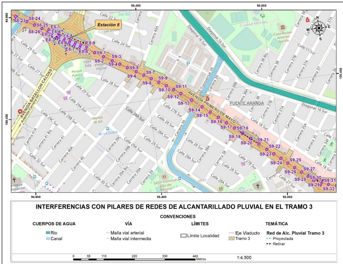
Figura 76 Interferencias con pilares de redes de Alcantarillado Pluvial en el tramo 3
