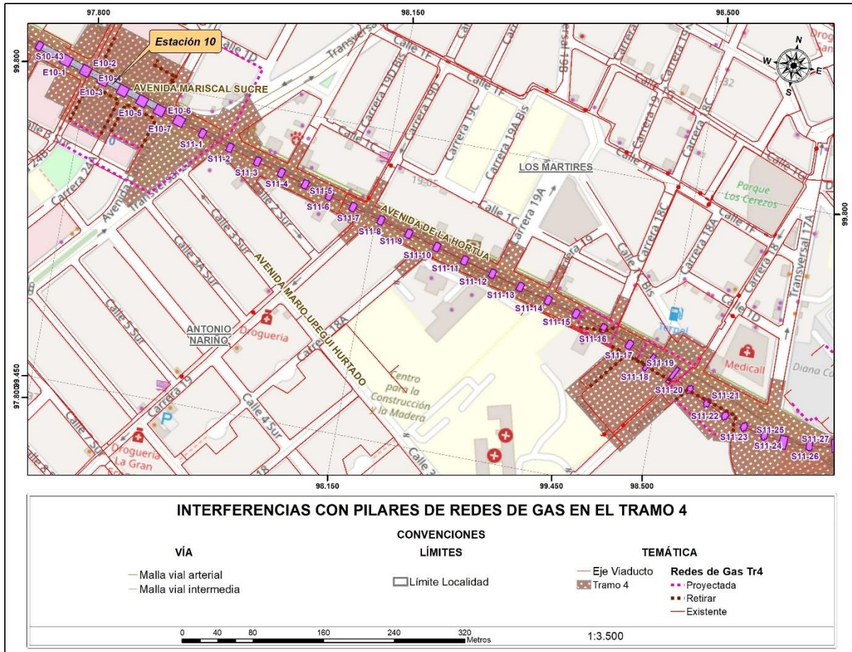
Figura 140 Interferencias con pilares de redes de Gas en el tramo 4
