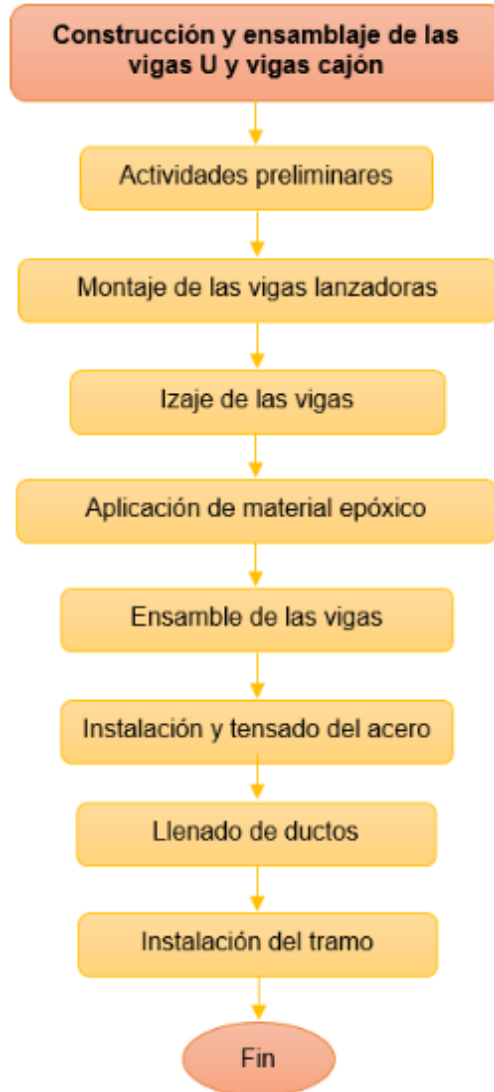
Figura 182 Proceso de ensamblaje Vigas
