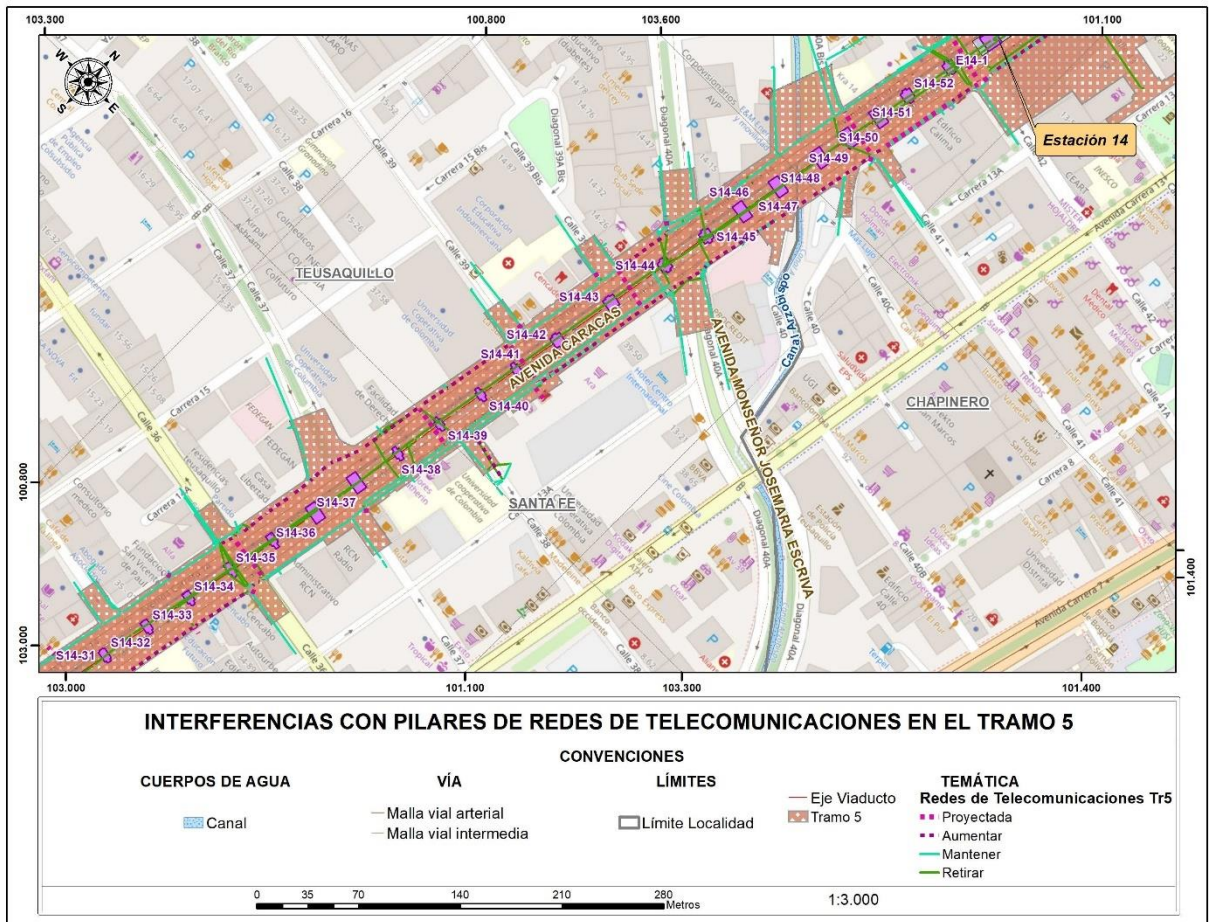
Figura 124 Interferencias con pilares de redes de Telecomunicaciones en el tramo 5
