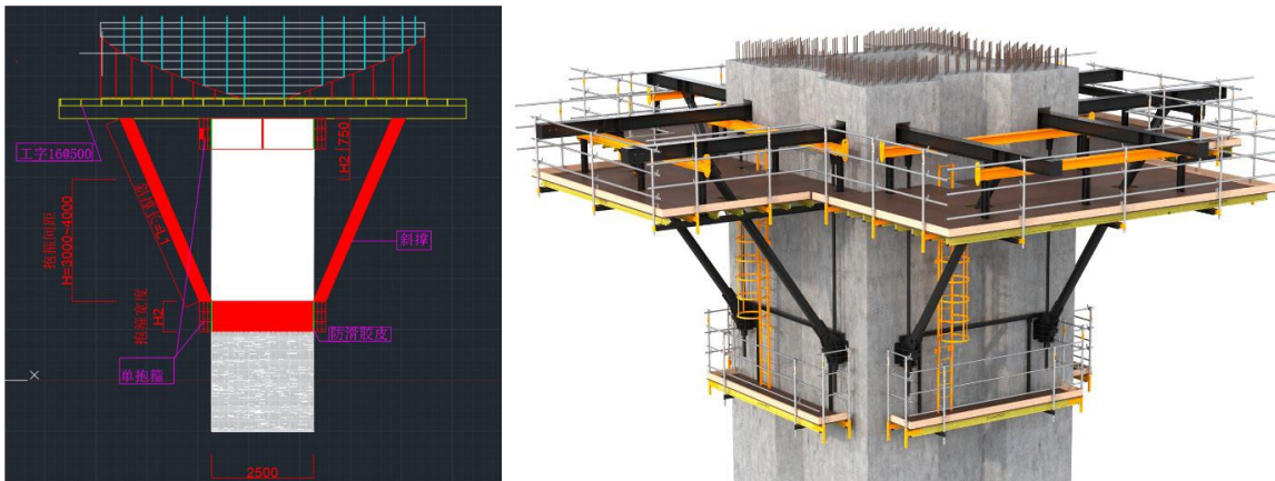
Figura 179 Encofrado viga capitel (fotos de referencia)
