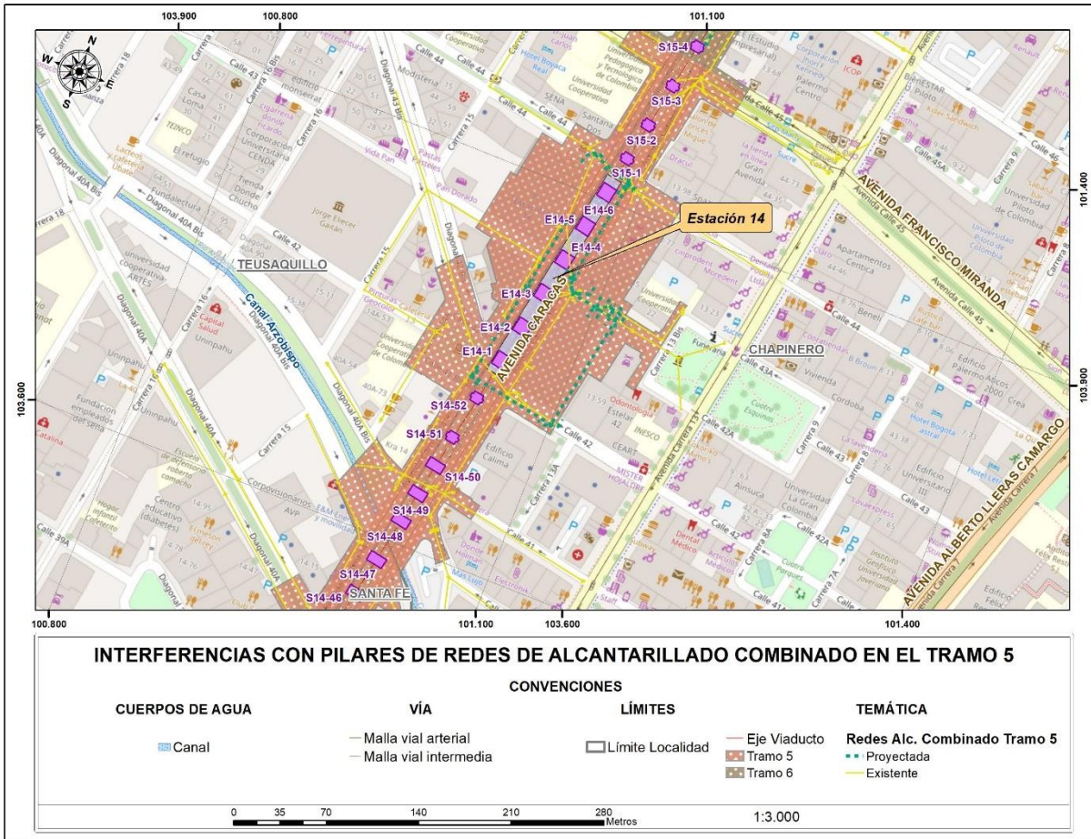
Figura 88 Interferencias con pilares de redes de Alcantarillado Combinado en el tramo 5
