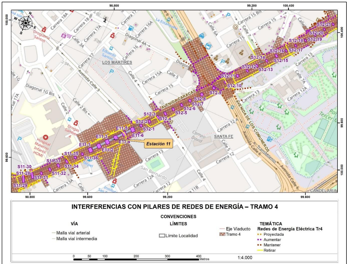
Figura 104 Interferencias con pilares de redes de Energía – tramo 4
