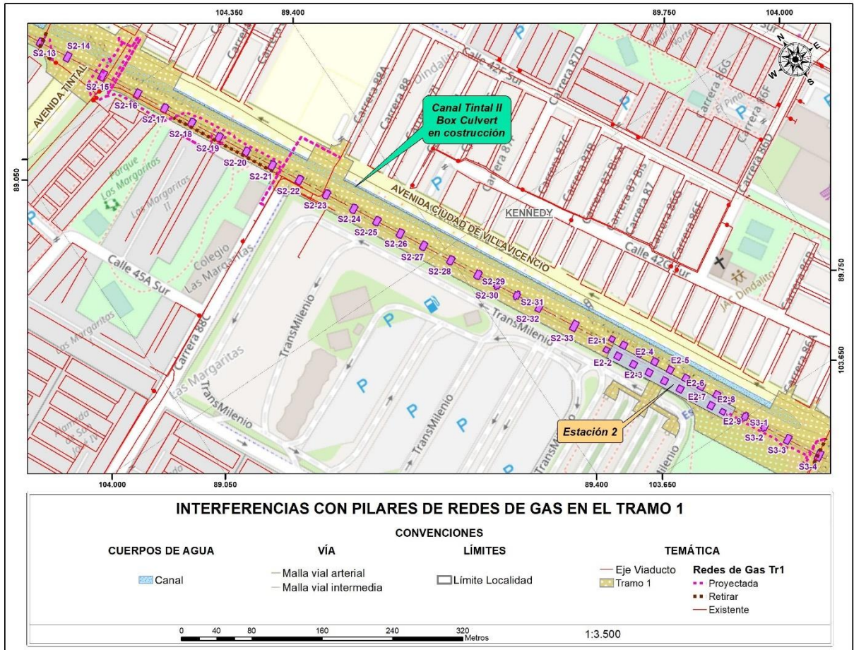
Figura 130 Interferencias con pilares de redes de Gas en el tramo 1
