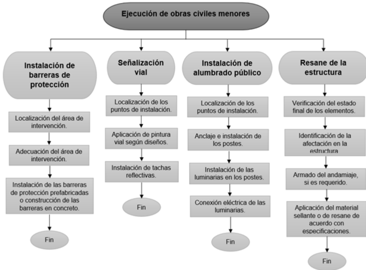
Figura 461 Diagrama ejecución de obras civiles menores
