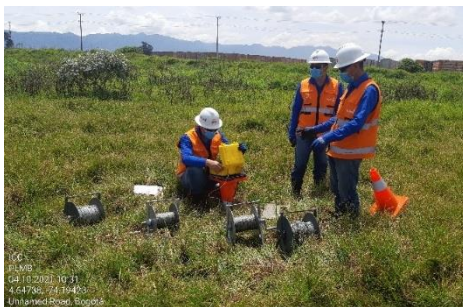
Fotografía 58 Arreglo Schlumberger para el SEV1-PLMB
