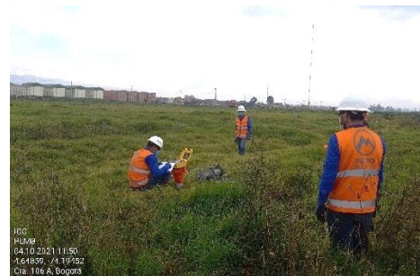
Fotografía 59 Toma de datos de resistividad en el SEV2-PLMB
