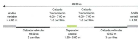
SECCIÓN TIPO 2 PARA ANCHO DE CORREDOR DE 60.00 m
