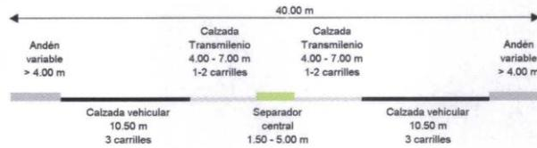
SECCIÓN TIPO 2 PARA ANCHO DE CORREDOR DE 60.00 m
