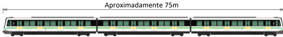
Figura 48. Longitud de un vehículo para tren pesado
