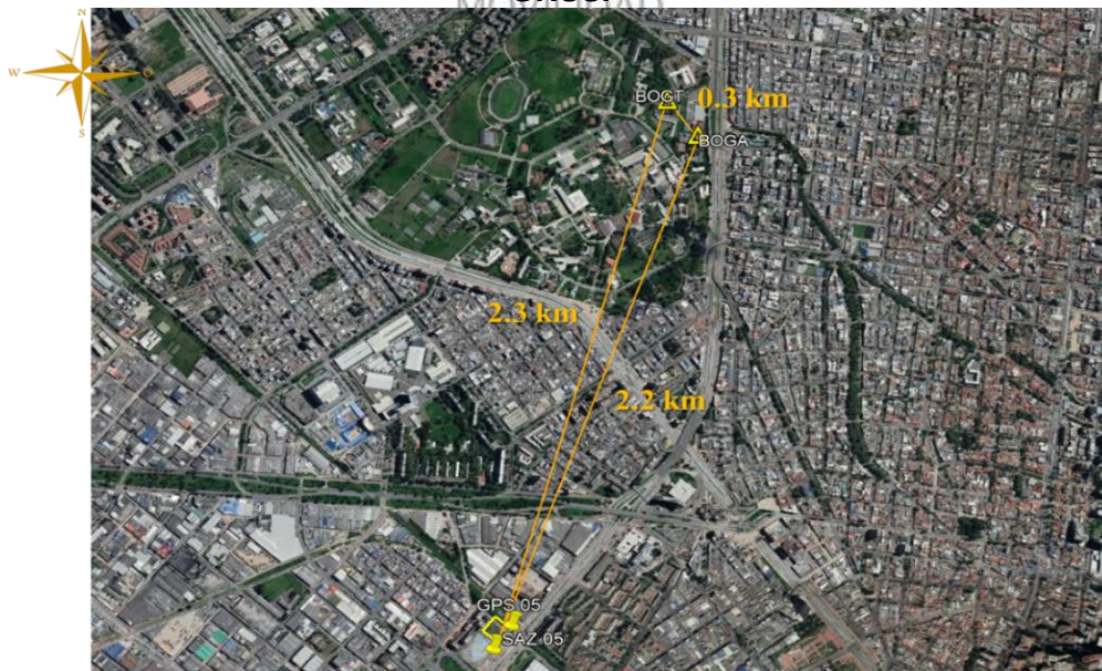
Figura 36. Distancia de vectores entre estaciones permanentes IGAC y puntos GNSS.
