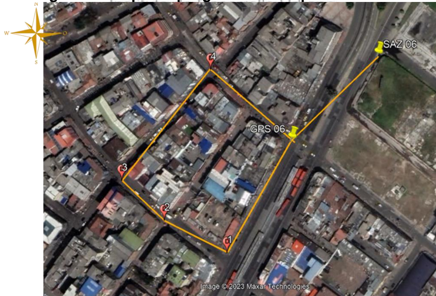
Figura 34. Esquema poligonal cerrada por ceros atrás.
