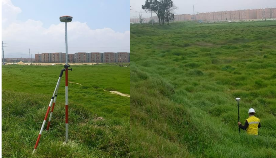
Figura 25. Levantamiento con metodología Stop and Go.
