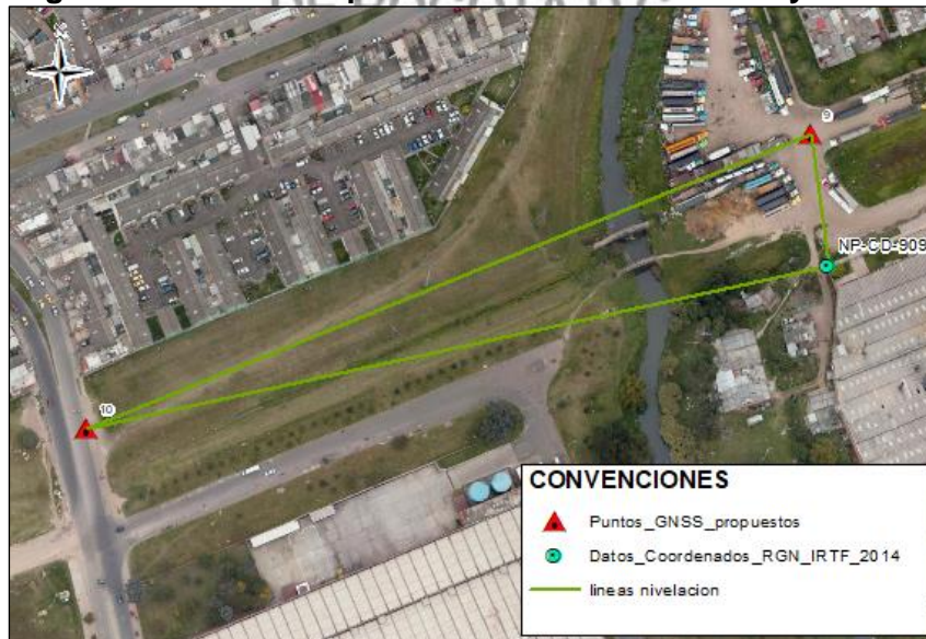
Figura 22. Nivelación puntos de control horizontal y vertical.
