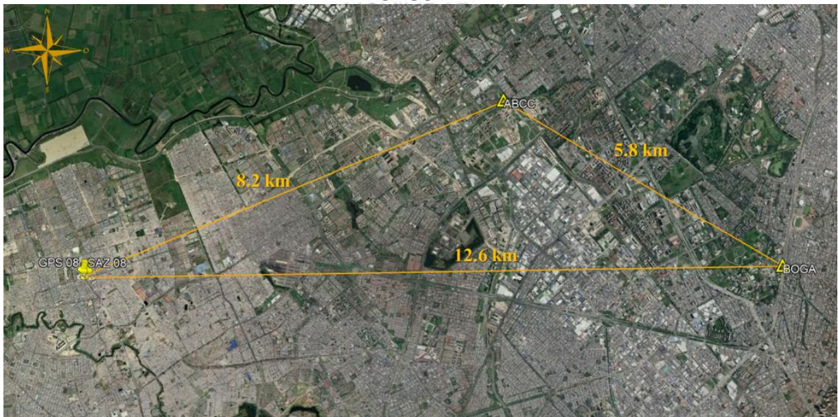
Figura 45. Distancia de vectores entre estaciones permanentes IGAC y puntos GNSS.
