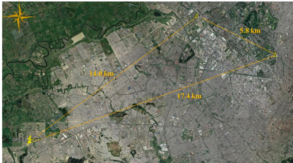
Figura 57. Distancia de vectores entre estaciones permanentes IGAC y puntos GNSS.
